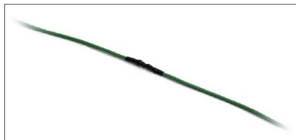
5. Нагреваем термоусадку, соединение готово!
