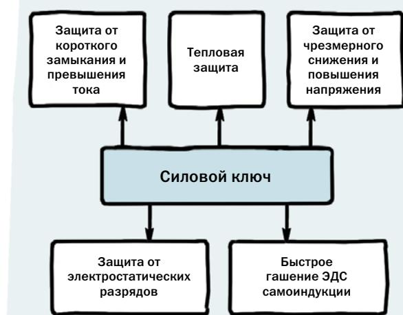
Структурная схема силового ключа
