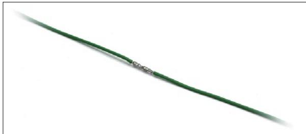
4. Пропаиваем оловянно-свинцовым припоем ПОС-61 с жидким флюсом ЛТИ-120 или другим нейтральным.
