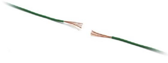
1. Снимаем изоляцию с проводов на расстоянии 1,5–2 см от края.
