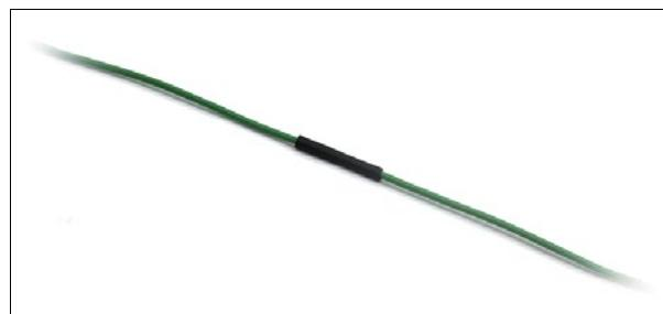
4. Перемещаем термоусадочную трубку на место пайки.
