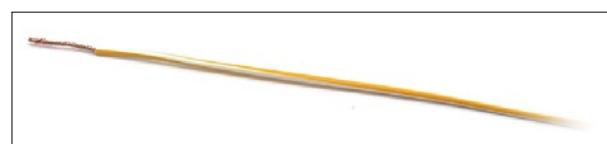
3. На втором проводе скручиваем между собой все жилки.
