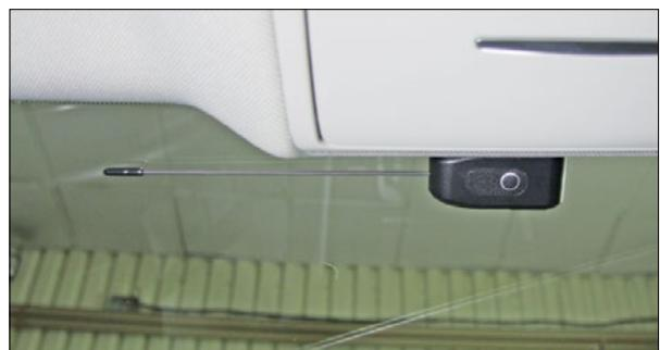
Модуль приемопередатчика на чистом лобовом стекле
