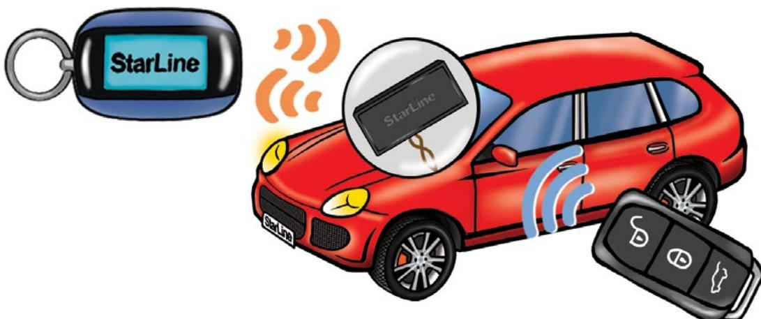
снятии с охраны штатной системы центральный блок начинает искать метку-брелок. Если метка-брелок опознана системой, то блокировка двигателя снимется. А вот если у злоумышленника нет метки, то автомобиль останется обездвиженным, с кричащей сиреной. При таком способе авторизации радиус опознавания брелока-метки составляет 5-20 метров и может быть отрегулирован при установке.
