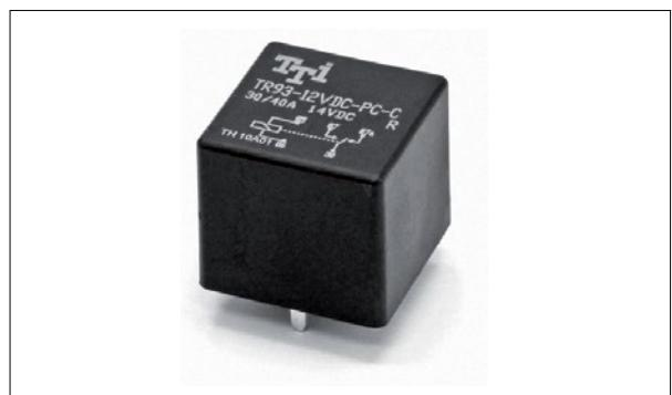
Неполяризованное автомобильное реле
