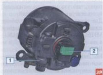
**Противотуманная фара:** 1 – регулировочный винт; 2 – лампа фары
