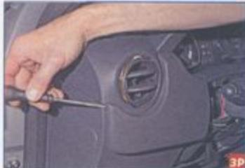
Отверткой поддеваем левую декоративную накладку панели приборов...
