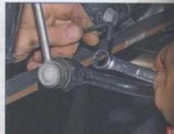
Аналогично отворачиваем гайку крепления пальца нижнего шарнира стойки к штанге стабилизатора...
