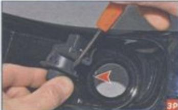
...выступ на корпусе регулятора (показан отверткой) должен войти в выемку на нижней накладке облицовки туннеля пола.
