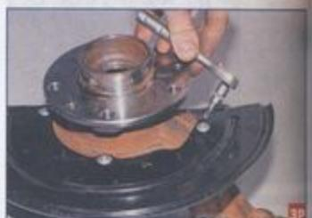
Ключом Torx T-30 отворачиваем три винта крепления тормозного щита...
