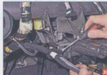
Поддев отверткой, снимаем держатель жгута проводов с кронштейна рулевой колонки.
