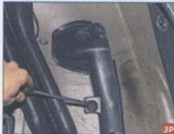
Шлицевой отверткой отворачиваем две пластмассовые гайки крепления защитного кожуха жгута проводов датчика.
