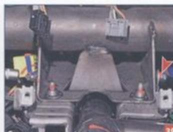
Головкой «на 10» отворачиваем две гайки...
