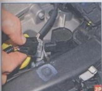
Нажав на фиксатор колодки проводов, отсоединяем колодку от катушки зажигания.
