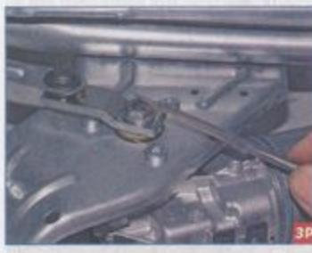
Надфилем помечаем положение кривошипа относительно вала мотор-редуктора.
