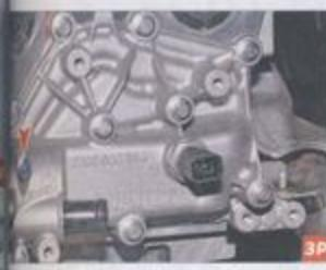
Затвор на корпусе термостата для выпуска воздуха из системы охлаждения при нагревности показано на демонтированном двигателе
