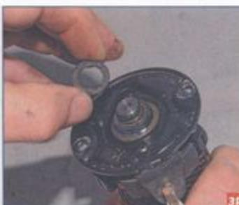
Снимаем дистанционную шайбу.
