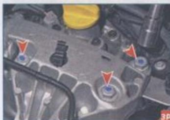
...три болта крепления кронштейна опоры к верхней крышке привода ГРМ...
