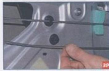
Выводим тягу блокировки замка двери из пластмассового держателя.
