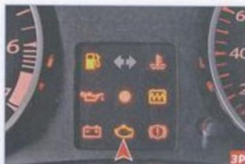
Сигнализатор неисправности системы управления в комбинации приборов
