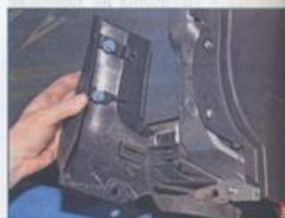
Поддев обвес порога и, преодолев сопротивление двух пистонов, снимаем обвес порога кузова.
