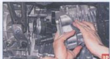
Сдвигаем раздаточную коробку по шпилькам картера сцепления...
