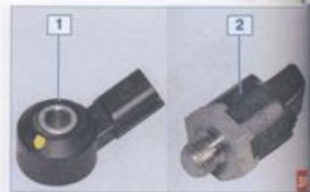
Датчик детонации: 1 – двигателя 2,0; 2 – двигателя 1,6
