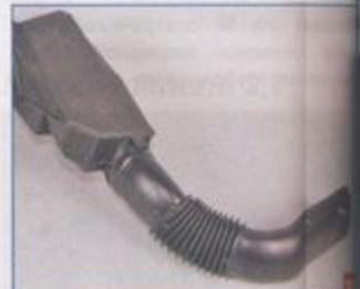
Воздухозаборник с резонатором в сборе автомобиля с двигателем 1,6. Устанавливаем воздухозаборник и резонатор воздушного тракта двигателя в обратной последовательности.
