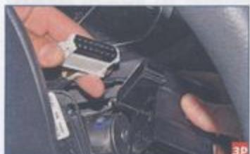
Сжав два фиксатора колодки проводов, отсоединяем колодку от разъема переключателя...
