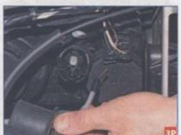
...и отсоединяем наконечник троса от штока исполнительного механизма регулятора направления пучков света фар.
