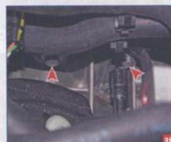
...головкой «на 8» отворачиваем два болта крепления стартера...
