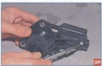
Ключом Torx T-20 отворачиваем винт крепления электропривода к корпусу цилиндрового механизма замка двери...
