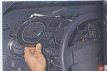
Снимаем комбинацию приборов. Светодиодные сигнализаторы, установленные в комбинации приборов впаяны в плату и замене не подлежат. При выходе из строя сигнализатора стрелочного прибора или дисплея, следует заменить комбинацию приборов новой.
