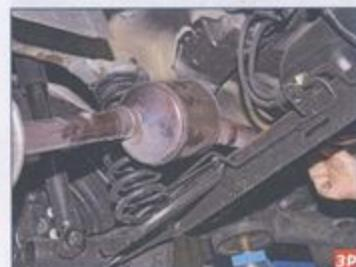
...и, пропустив детали системы выпуска между балкой задней подвески и днищем кузова...
