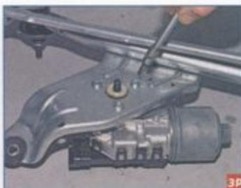
Ключом Торх Т-30 отворачиваем три винта крепления мотор-редуктора к кронштейну очистителя...
