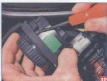
Отверткой поочередно отжимаем два фиксатора (второй фиксатор на фото не виден)...
