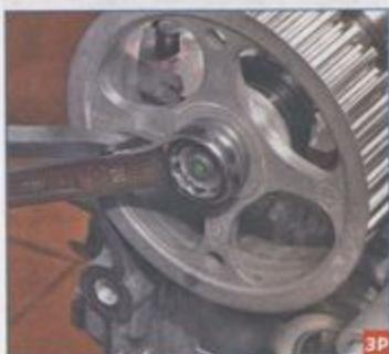
Опираясь на спицу шкива лезвием отвертки, стержнем отвертки надавливаем на ключ и поворачиваем его против часовой стрелки.
