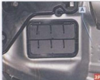
Клапаны выхода воздуха из салона (показано при снятом заднем бампере)
