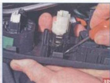
Отверткой поочередно нажимаем на два фиксатора (второй фиксатор на фото не виден)...
