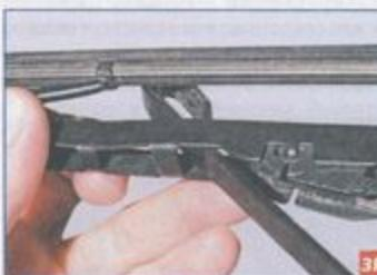
...и сдвигаем щетку к основанию рычага так, чтобы фиксатор щетки вышел из крюка рычага.
