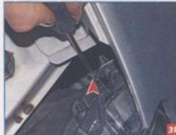
Отверткой отжимаем фиксатор...
