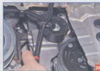
...головкой «на 13» отворачиваем болт крепления ролика.
