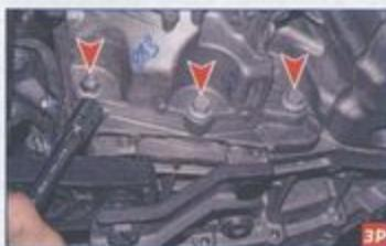
Тем же инструментом отворачиваем нижнюю гайку шпильки крепления раздаточной коробки к картеру сцепления и два нижних болта.
