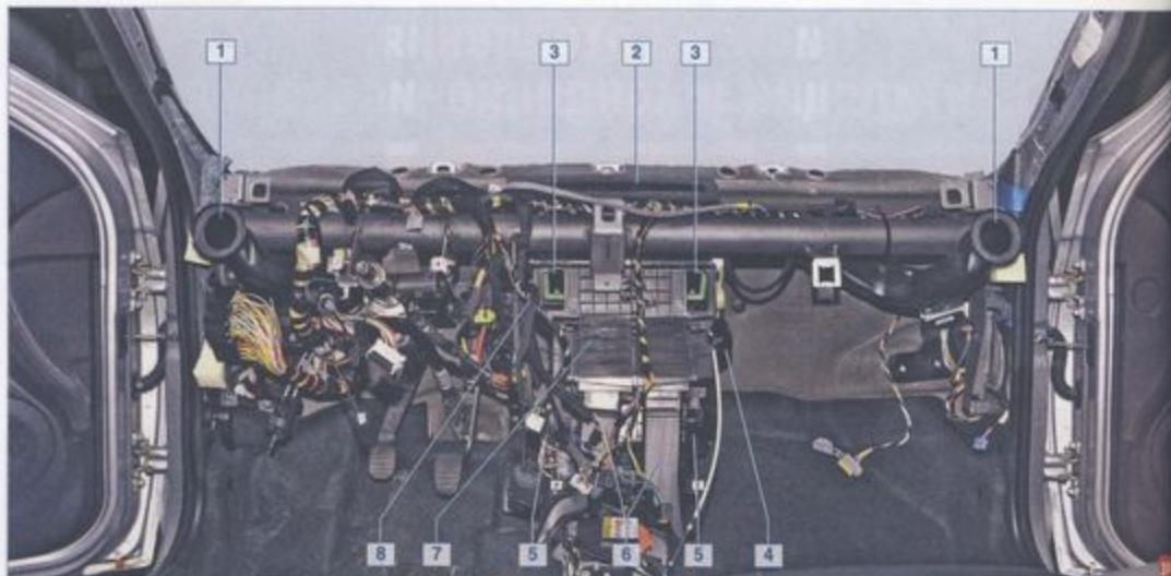
**Расположение отопителя и воздуховодов системы отопления, вентиляции и кондиционирования (показано при снятой панели приборов):** 1 – воздуховод к боковому дефлектору; 2 – воздуховод к решетке обдува ветрового стекла; 3 – воздуховод к центральным дефлекторам; 4 – электродвигатель вентилятора отопителя; 5 – воздуховоды к ногам передних пассажиров; 6 – воздуховоды к ногам пассажира заднего сиденья; 7 – отопитель; 8 – дополнительный резистор вентилятора отопителя
