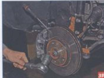
Вставив отвертку в вентиляционное отверстие тормозного диска и оперев ее на направляющую тормозных колодок, окончательно отворачиваем гайку крепления подшипника ступицы колеса.
