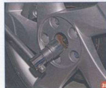
Головкой «на 30» ослабляем гайку крепления подшипника ступицы колеса. Вывешиваем и снимаем колесо.
