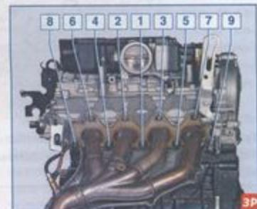
Последовательность затяжки гаек крепления выпускного коллектора (для наглядности показываем на снятом двигателе).
