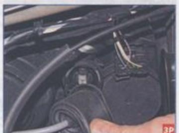
Снимаем защитный чехол с корпуса исполнительного механизма регулятора направления пучков света фар.
