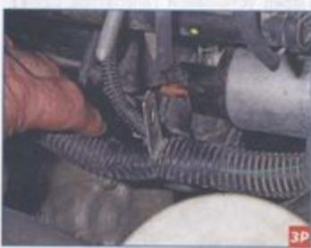
...и снимаем наконечник провода с контактного болта тягового реле.
