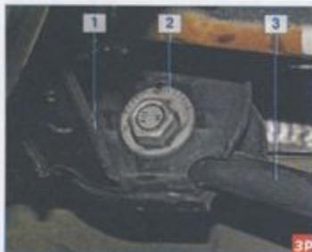
Соединение заднего поперечного рычага с подрамником: 1 – кронштейн подрамника; 2 – болт с эксцентриковым пояском и шайбой; 3 – задний поперечный рычаг
