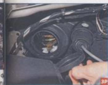
...снимаем защитный резиновый чехол фары ближнего и габаритного света.
