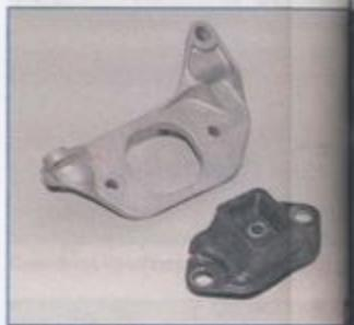
Левая опора силового агрегата с кронштейном.
