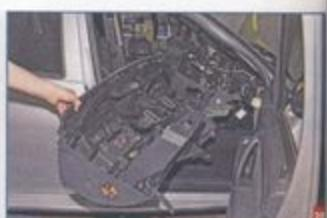
Вынимаем панель приборов из салона автомобиля.
