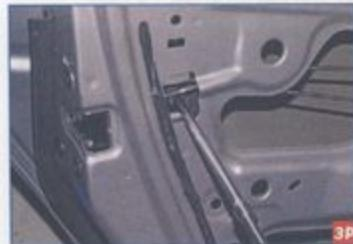
Тем же инструментом отворачиваем другую гайку крепления наружной ручки двери.
