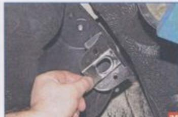
Снимаем с отбортачки бака металлическую прокладку. Аналогично снимаем другую металлическую прокладку. Немного приспустив бак на упоре...
