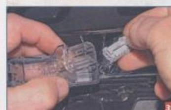
...нажав на фиксатор колодки проводов, отсоединяя колодку от разъема фонаря.
