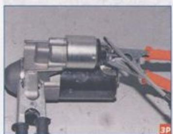
Отверткой перемыкаем верхний контактный болт и управляющий вывод тягового реле.
