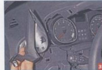
...снимаем ее, преодолевая сопротивление фиксаторов.
