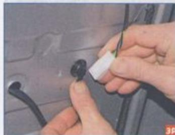
...и, сдвинув колодку жгута проводов наружного зеркала вверх, снимаем ее с пластмассового держателя.
