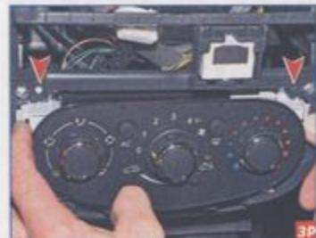
Проталкиваем блок в проем панели приборов, выводя два штифта блока из отверстий панели приборов...
