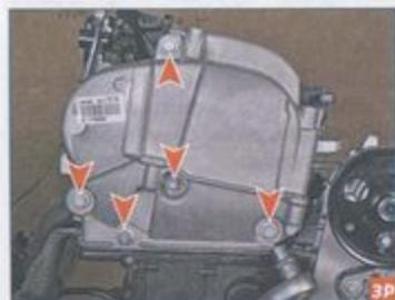
Головкой «на 13» отворачиваем три болта и две гайки крепления верхней крышки привода ГРМ...
