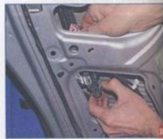
Сдвигнув замок в сторону технологического отверстия в двери, отжимая фиксатор колодки жгута проводов...
