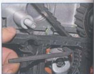
...ослабляем ключом «на 13» затяжную гайку крепления натяжного ролика и шестигранником «на 6» поворачиваем ролик по часовой стрелке (натягивая ремень) до момента совмещения указателей.
