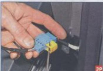
Отверткой сдвигаем фиксатор колодок...
