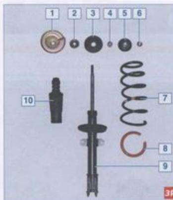
**Детали амортизаторной стойки:** 1 – верхняя опорная чашка пружины; 2 – подшипник верхней опоры; 3 – верхняя опора стойки; 4 – гайка крепления верхней опоры; 5 – резинометаллическая опорная шайба; 6 – гайка крепления стойки к кузову; 7 – пружина; 8 – виброшумопоглощающий чехол пружины; 9 – телескопическая стойка; 10 – буфер хода сжатия с защитным чехлом
