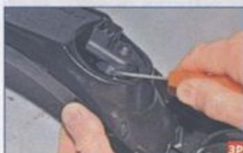
Отверткой поочередно нажимаем на два фиксатора (второй фиксатор на фото не виден)...
