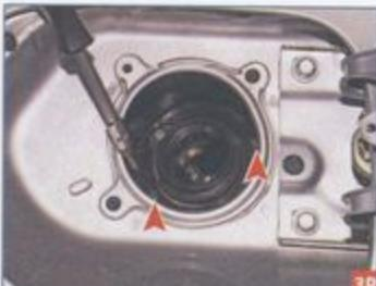
Ключом Торх T-20 отворачиваем два самореза крепления горловины к наливной трубе.
