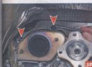
жидким ключом «на 8» отворачиваем два болта крепления верхнего защитного экрана к фланцу выпускного коллектора (для наглядности вилка ширма переднего карданного вала поддвинена от фланца выходного вала задаточной коробки).
