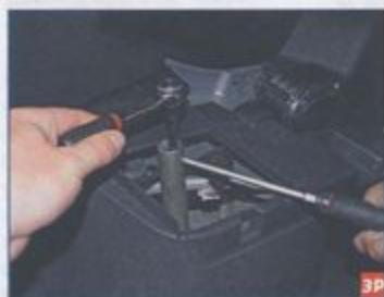
Трубчатым ключом «на 21» (можно воспользоваться «свечным» ключом для автомобилей ВАЗ) ослабляем затяжку гайки крепления штока амортизаторной стойки к кузову, удерживая шток амортизатора от проворачивания шестигранником «на 6».
