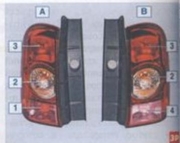
**Расположение ламп в задних фонарях:** А – левый фонарь; В – правый фонарь; 1 – противотуманного света; 2 – указателя поворота; 3 – сигнала торможения и габаритного света; 4 – света заднего хода
