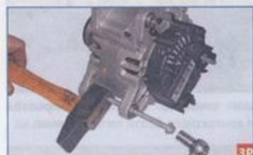
...и, вращая головкой «на 10» болт, сдвигаем втулку.
