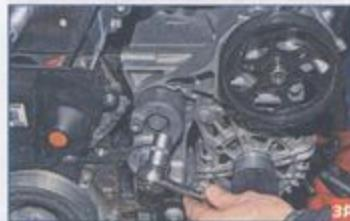
...головкой «на 16» отворачиваем болт крепления натяжного устройства (для наглядности показано на снятом двигателе).
