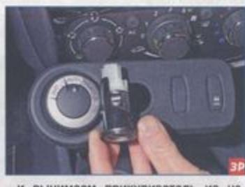
...и вынимаем прикуриватель из накладки.
