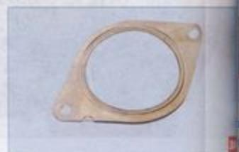
Соединение фланцев выпускного коллектора и металлокомпенсатора уплотнено многослойной термостойкой прокладкой
