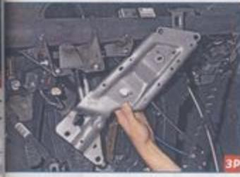
и снимаем кронштейн поперечной
