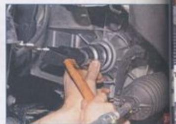
Оправкой подходящего размера за-прессовываем сальник в гнездо картера коробки передач.
