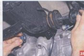
Передние опоры крепятся к подрамнику задней подвески специальными длинными болтами с гайками
