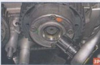
Головкой «на 18» с воротком отворачиваем болт крепления исполнительного механизма.
