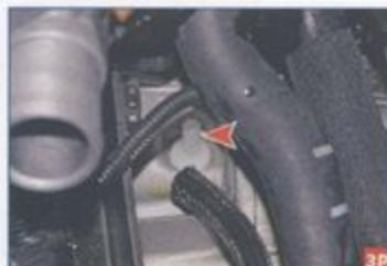
...и снимаем шланг сапуна с пластмассовой втулки.
