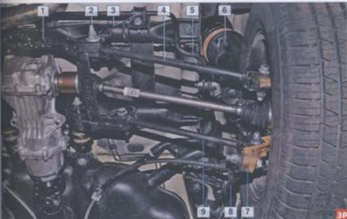
Элементы задней подвески на автомобиле: 1 – подрамник; 2 – болт с эксцентриковой шайбой; 3 – скоба крепления штанги стабилизатора поперечной устойчивости; 4 – задний поперечный рычаг; 5 – штанга стабилизатора поперечной устойчивости; 6 – амортизаторная стойка; 7 – кулак; 8 – продольный рычаг; 9 – передний поперечный рычаг
