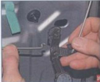
...и вынимаем тягу из отверстия рычага.
