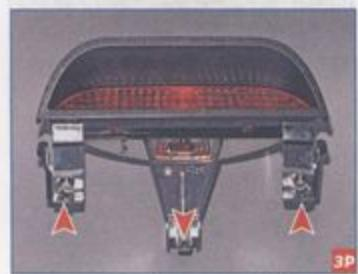
Расположение фиксаторов (для наглядности показано на снятом сигнале).
