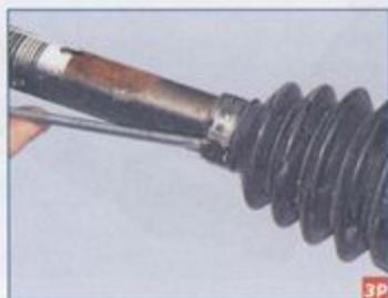
Отверткой разжимаем замок малого
