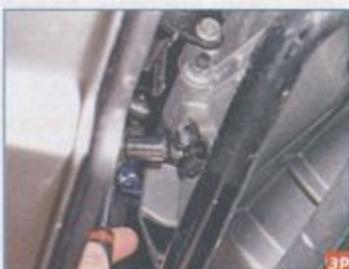
Головкой «на 10» отворачиваем болт крепления датчика...
