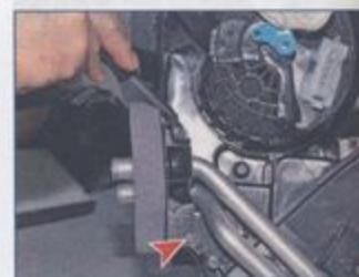
Ключом Торх T-20 отворачиваем держатель...
