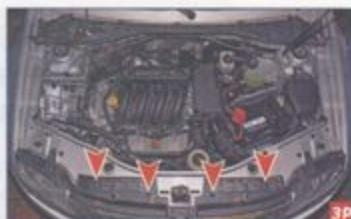
Расположение винтов крепления бампера к верхней поперечине рамки радиатора.
