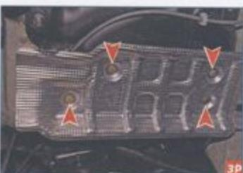
К дну бака четырьмя пистонами крепится теплозащитный экран дополнительного глушителя.
