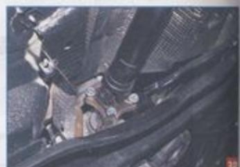
Головкой «на 16» с удлинителем отворачиваем болты крепления вилки шарнира переднего карданного вала к фланцу выходного вала раздаточной коробки.
