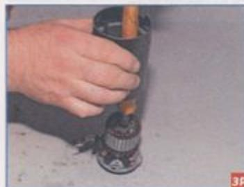
...придерживаем ручкой молотка якорь от притягивания его постоянными магнитами статора и опускаем корпус на заднюю крышку.
