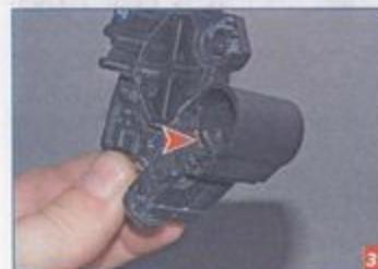
...и, сдвинув крышку щеток, фиксируем щетки.
