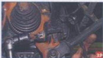
Головкой «на 21» отворачиваем гайку болта крепления проушины рычага к кулаку задней подвески, удерживая головку болта крепления рычага к подрамнику.
