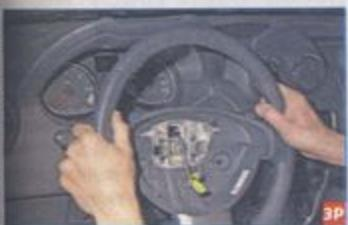
Покачивая, тянем на себя рулевое колесо и снимаем его со шлицевого вала.
