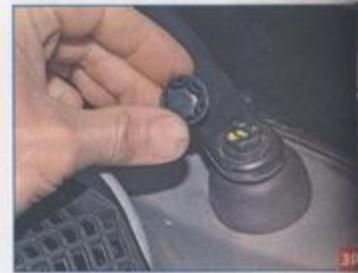
Снимаем защитный колпачок с гайки крепления рычага щетки.
