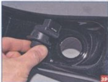
...вынимаем регулятор электропривода наружных зеркал заднего вида из отверстия в нижней накладке (см. «Снятие выключателей, регулятора, прикуривателя и блока сигнализаторов», с. 265).
