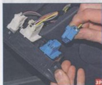
...отсоединяем ее от выключателя управления электростеклоподъемниками передних дверей.
