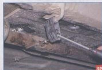
С помощью большой отвертки стягиваем с кронштейна трубы подушку. Аналогично впрыскиваем мыльный раствор в зазор между кронштейном кузова и подушкой.
