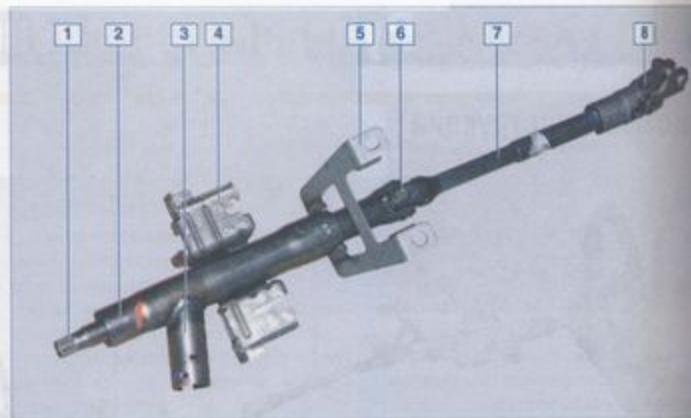
**Рулевая колонка:** 1 – вал рулевой колонки; 2 – труба рулевой колонки; 3 – гнездо выключателя зажигания; 4 – задний кронштейн крепления колонки; 5 – передний кронштейн крепления колонки; 6 – верхний карданый шарнир; 7 – промежуточный вал; 8 – нижний карданый шарнир
