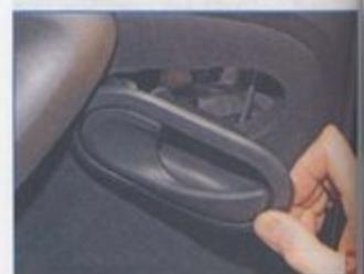
...и вынимаем ее из обивки двери...
