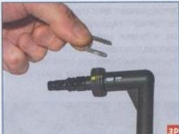
...поддев отверткой, снимаем фиксатор переходника.
