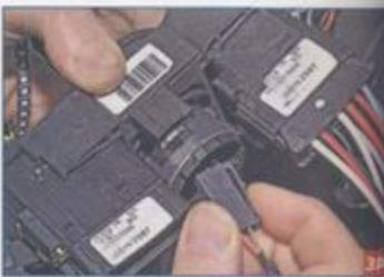
Нажав на фиксатор колодки проводов, отсоединяем колодку от разъема соединителя...
