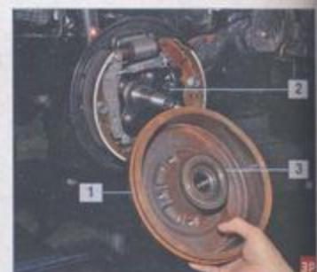
Расположение задающего диска и датчика скорости заднего колеса автомобиля 4x2: 1 – барабан тормозного механизма; 2 – датчик скорости вращения заднего колеса; 3 – задающий диск датчика скорости
