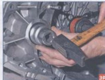
Оправкой подходящего размера за-прессовываем сальник в гнездо картера сцепления.
