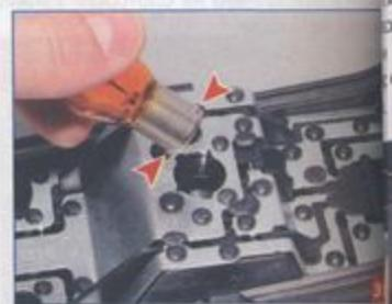
Лампа указателя поворота имеет два выступа, расположенных несимметрично относительно оси лампы, которые должны войти в соответствующие пазы гнезда держателя.
