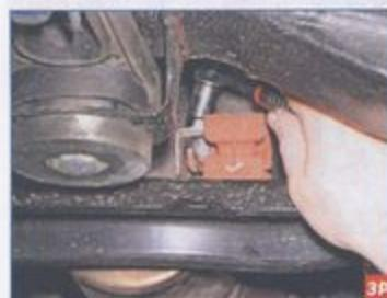
...головкой «на 13» отворачиваем болт крепления подушки к кронштейну, приваренному к переднему торцу нейтрализатора.
