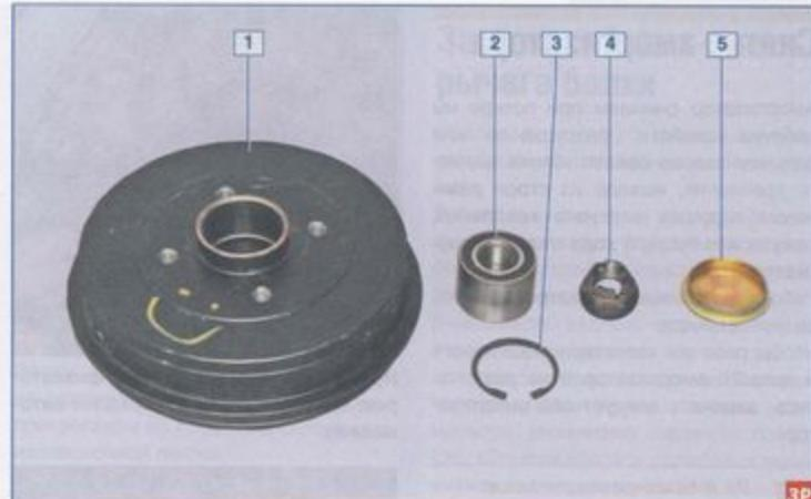
Узел подшипника заднего колеса: 1 – барабан тормозного механизма; 2 – подшипник заднего колеса; 3 – стопорное кольцо подшипника; 4 – гайка подшипника; 5 – колпачок
