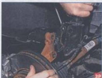
Отсоединяем амортизаторную стойку от поворотного кулака (см. «Снятие амортизаторной стойки и ее разборка», с. 180).
