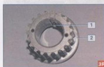
...его выступ 1 (выполняющий роль шпонки) должен войти в паз на носке коленчатого вала, а фланец 2 шкива должен быть обращен к крышке блока цилиндров.
