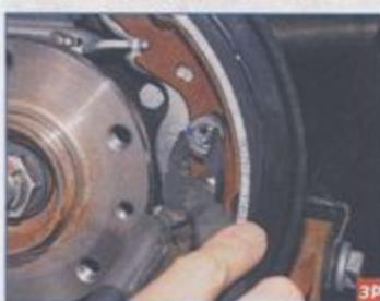
Пассатижами поворачиваем чашку пружины опорной стойки задней колодки до совмещения паза в чашке с хвостовиком стойки.
