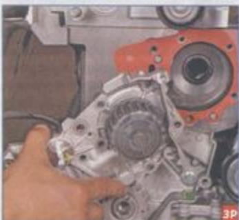
...и снимаем насос охлаждающей жидкости.
