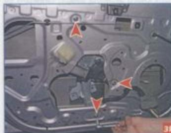
Головкой «на 10» отворачиваем три гайки крепления механизма стеклоподъемника к внутренней панели двери.
