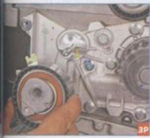
и натяжной ролик ремня (см. «Проверка состояния и замена ремня привода газораспределительного механизма», с. 67).
