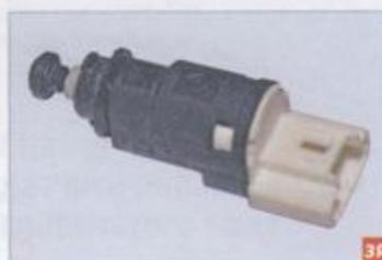
Выключатель сигналов торможения
