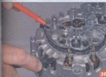
...«плюс» цифрового тестера (в режиме проверки диодов) подсоединяя к выводу «B+» генератора, а «минус» – к корпусу.
