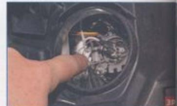
Нажав на пружинный фиксатор лампы, выводим его из зацепления с крючками отражателя (для наглядности показано на снятой блок-фаре)...
