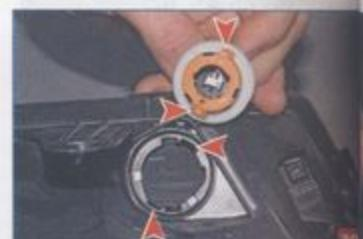
Патрон лампы указателя поворота имеет два фиксирующих выступа разной ширины, которые должны войти в соответствующие пазы корпуса блок-фары.
