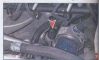
Расположение датчика сигнализатора недостаточного давления масла.
