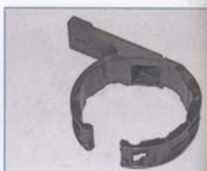
...и снимаем хомут крепления бачка. Собираем и устанавливаем вентилятор с кожухом в обратной последовательности. При необходимости заменяем втулки верхней опоры кожуха вентилятора...
