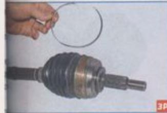
Вскрыв замок хомута, снимаем хомут.
