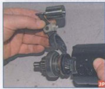
Снимаем рычаг привода.
