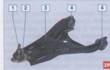
**Рычаг:** 1 – шаровая опора; 2 – защитный чехол шаровой опоры; 3 – рычаг; 4 – сайлент-блоки
