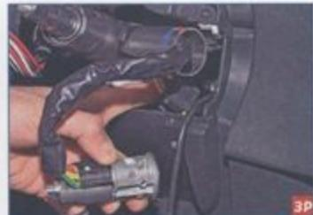
Ключом Torx T-20 отворачиваем винт крепления выключателя зажигания. Вставив ключ в выключатель зажигания, поворачиваем его...
