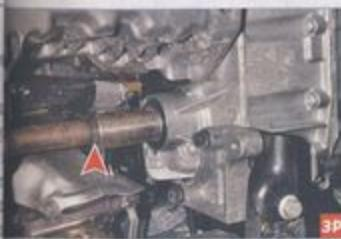
Лицевой конец хвостовика корпуса внутреннего шарнира привода правого колеса вставлен в отверстие выходного вала полуосевой шестерни дифференциала
