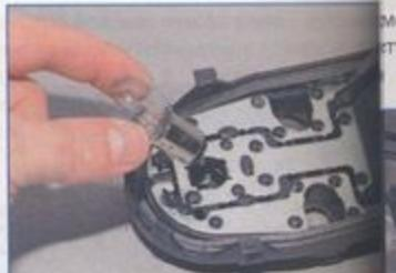
...вынимаем комбинированную лампу сигнала торможения и габаритного света из держателя.
