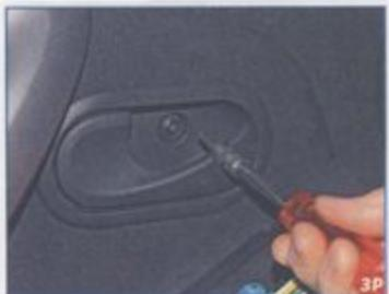
Ключом Torx T-30 отворачиваем винт крепления внутренней ручки двери...
