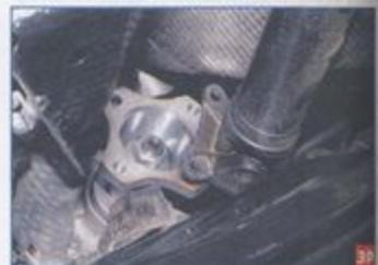
...и, сдвинув карданный вал назад, выводим центрирующий буртик фланца вилки шарнира из фланца выходного вала раздаточной коробки.
