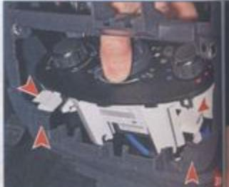
...и сдвигаем держатели блока с четырех панели приборов.
