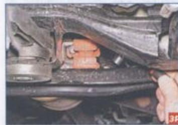
Головкой «на 10» отворачиваем два болта крепления подушки к поперечине кузова...
