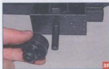
Снимаем резиновые подушки нижних опор с пальцев кожуха вентилятора.
