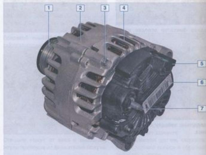
Генератор: 1 – шкив генератора; 2 – передняя крышка; 3 – стяжной болт; 4 – задняя крышка; 5 – разъем щеткодержателя; 6 – кожух; 7 – вывод «B+»
