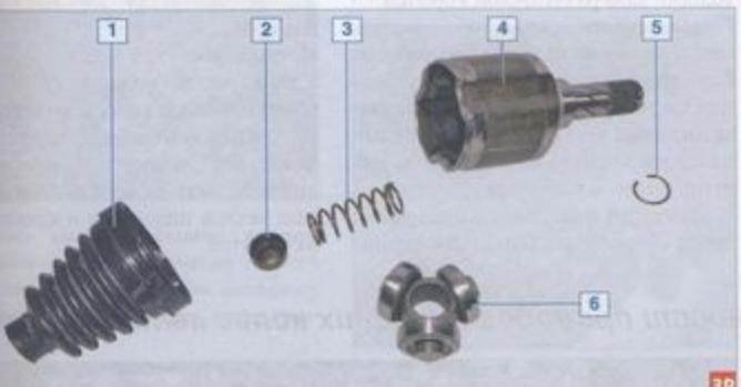
Детали внутреннего шарнира привода левого колеса: 1 – грязезащитный чехол; 2 – упорная шайба пружины; 3 – пружина; 4 – корпус внутреннего шарнира; 5 – стопорное кольцо; 6 – трехшповник
