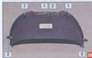
Расположение фиксаторов 1 и направляющих штифтов 2 на нижней накладке козырька.
