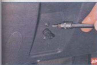
Ключом Torx T-20 отворачиваем два самореза крепления регулятора направления пучков света фар...
