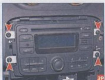
Ключом Торх T-20 отворачиваем четыре самореза крепления головного устройства.
