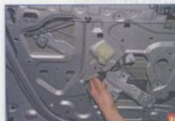
Вынимаем механизм электростеклоподъемника через технологическое отверстие во внутренней панели двери...
