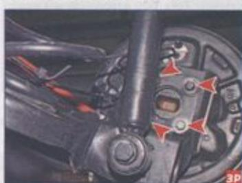
Цапфа заднего колеса крепится четырьмя винтами через щит тормозного механизма с фланцу балки задней подвески
