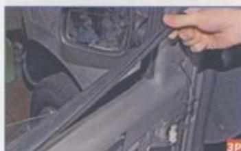
Поддеваем передний край внутреннего уплотнителя стекла двери и снимаем его с внутренней панели двери. Подключив колодку жгута проводов к выключателю блока управления электростеклоподъемниками передних дверей, опускаем стекло так, чтобы был доступ к саморезам крепления держателей стекла к ползуну стеклоподъемника.
