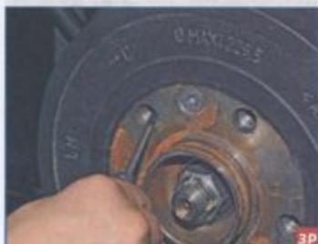
...шлифцовой отверткой через резьбовое отверстие в ступице (барабане – на автомобиле 4×2) вращаем храповую гайку механизма автоматической регулировки зазора между колодками и барабаном, уменьшая тем самым длину распорной планки.
