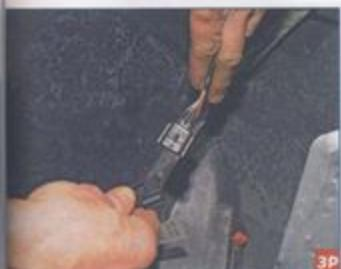
...и с левой стороны автомобиля разъединяем колодку жгута проводов датчиков заднего парктроника.
