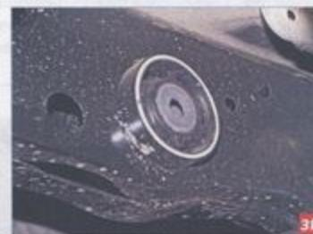
Задняя опора редуктора запрессована в подрамник задней подвески
