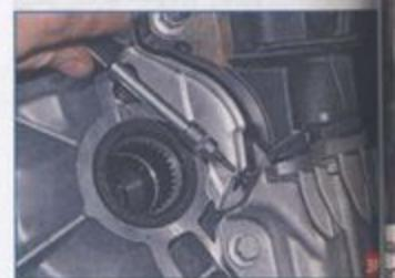
Ключом Torx T-20 отворачиваем пластмассовый фиксатор пистона крепления защитного кожуха...
