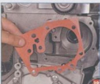
Снимаем уплотнительную прокладку. Заменив уплотнительную прокладку, устанавливаем насос охлаждающей жидкости в обратной последовательности. Затягиваем болты крепления насоса в указанной последовательности предписанными моментами (см. «Приложения», с. 314).
