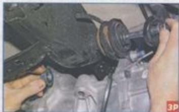
Вынимаем из опоры болт с увеличенной шайбой.
