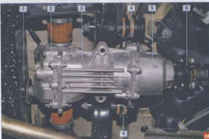
**Задний редуктор на автомобиле:** 1 – задняя опора; 2 – задняя крышка; 3 – картер редуктора; 4 – передние опоры; 5 – корпус электромагнитной муфты; 6 – фланец электромагнитной муфты
