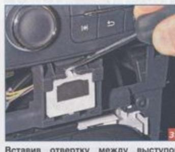
Вставив отвертку между выступом на корпусе блока и перемычкой на консоли приборов...
