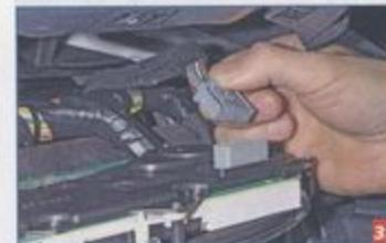
Аналогично отсоединяем от комбинации приборов колодку проводов серого цвета.
