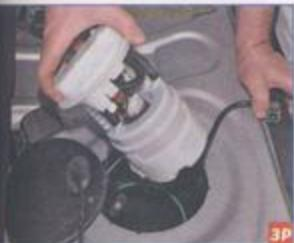
Зримаем топливный модуль из бака, ведь поплавок датчика указателя уровня топлива из отверстия в баке.
