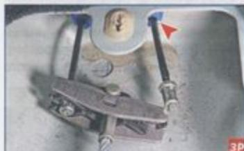
...пассатижами сжимаем лепестки фиксатора переднего наконечника оболочки троса и выталкиваем наконечник из отверстия в днище.
