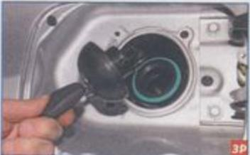
Снимаем пробку наливной горловины...
