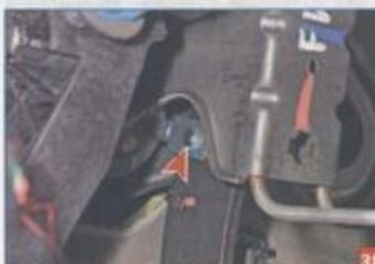
Снимаем с пальца крепления толкателя к педали тормоза разрезное пластмассовое стопорное кольцо.
