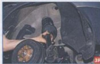
...и снимаем амортизаторную стойку.
