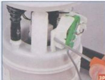
Освобождаем фиксатор датчика указателя уровня топлива.
