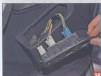
...извлекаем его из отверстия в обивке двери.
