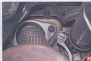
**Соединение фланцев выпускного коллектора и металлокомпенсатора**
