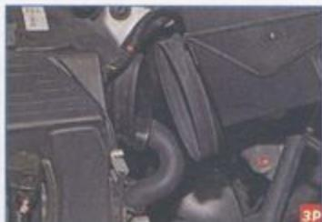
Отсоединяем патрубок резонатора от патрубка крышки корпуса воздушного фильтра.
