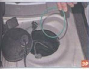
Зримаем уплотнительное резиновое кольцо топливного модуля.
