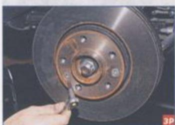
Ключом Torx T-40 отворачиваем два винта крепления диска тормозного механизма к ступице переднего колеса. Для удержания диска от проворачивания можно ввернуть в резьбовое отверстие ступицы болт крепления колеса и вставить монтажную лопатку между болтом и буртиком ступицы.
