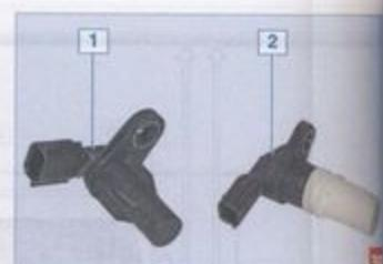
Датчик положения коленчатого вала: 1 – двигателя 2,0; 2 – двигателя 1,6
