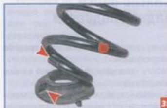
Монтируем пружину так, чтобы конец ее нижнего витка уперся в уступ прокладки (для наглядности показано на снятой прокладке).
