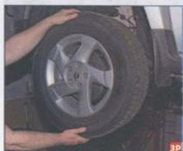
Взявшись за колесо, качаем его в вертикальной плоскости (несколько раз поочередно резко тянем верхнюю часть колеса на себя, а нижнюю – от себя, и наоборот).
