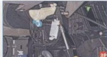
Ключом Torx T-20 отворачиваем саморез крепления резистора.
