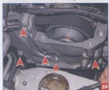
Головкой «на 13» отворачиваем три болта и две гайки крепления верхней крышки привода ГРМ...
