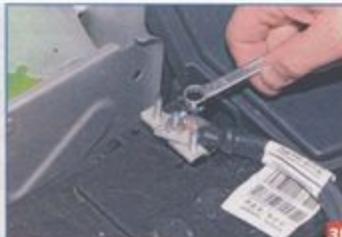
Накидным ключом «на 10» отворачиваем гайку...
