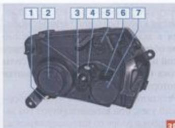
**Блок-фара:** 1 – ручка регулировки пучка света фары в горизонтальной плоскости; 2 – защитный чехол ламп ближнего и габаритного света; 3 – исполнительный механизм регулятора направления пучков света фары; 4 – винт регулировки пучка света фары в вертикальной плоскости; 5 – патрон лампы указателя поворота; 6 – разъем фары; 7 – защитный чехол лампы дальнего света
