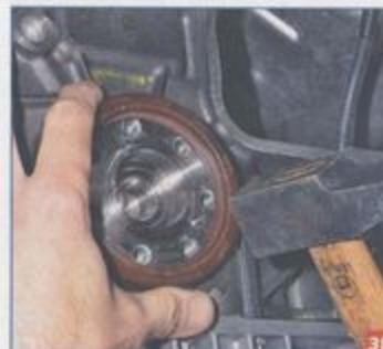
Используя старый сальник в качестве оправки, запрессовываем в гнездо блока цилиндров новый сальник. Маховик устанавливаем по ранее нанесенным меткам. Перед вворачиванием болтов крепления маховика наносим на их резьбовую часть герметик. Заворачиваем и равномерно затягиваем болты крепления маховика предписанным моментом (см. «Приложения», с. 314). Дальнейшую сборку выполняем в обратной последовательности.
