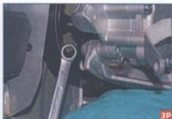
Тем же инструментом отворачиваем нижний болт крепления насоса к кронштейну двигателя.
