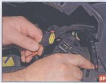
...и отсоединяем колодку проводов выключателя зажигания от колодки жгута проводов.
