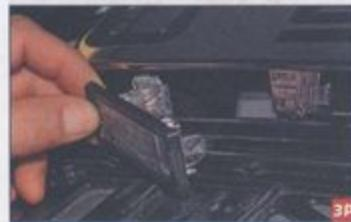
...и вынимаем фонарь из отверстия двери багажного отделения.
