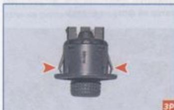
Регулятор электропривода наружных зеркал (стрелками показаны фиксаторы).
