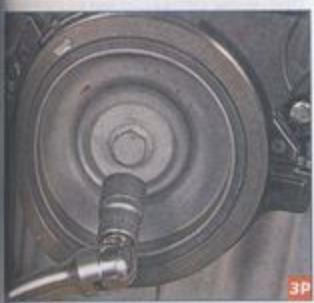
Головкой «на 18» отворачиваем болт крепления шкива привода вспомогательных агрегатов...
