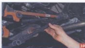
Снимаем задний поперечный рычаг.
