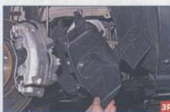
...и снимаем грязезащитный щиток моторного отсека.
