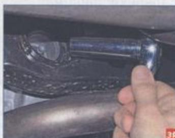
Головкой «на 18» отворачиваем гайку шпильки крепления редуктора к задней опоре.
