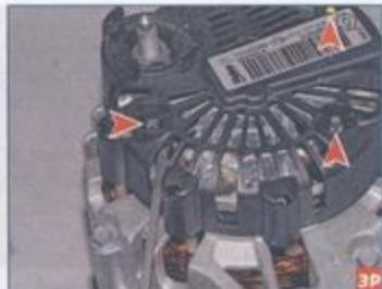
Поддев отверткой, сдвигаем кожух генератора с трех шпилек...
