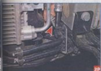
...и вынимаем болт левого крепления радиатора гидроусилителя рулевого управления.
