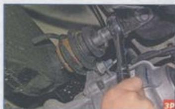
Головкой «на 18» отворачиваем гайку крепления передней опоры к заднему подрамнику, удерживая болт от проворачивания головкой «на 17».
