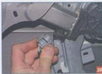
Нажимаем на фиксаторы колодки проводов и отсоединяем колодку от электродвигателя стеклоподъемника.
