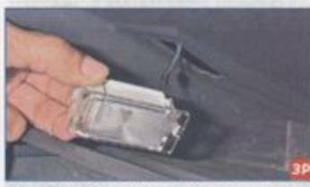
...и вынимаем плафон из отверстия вещевого ящика.
