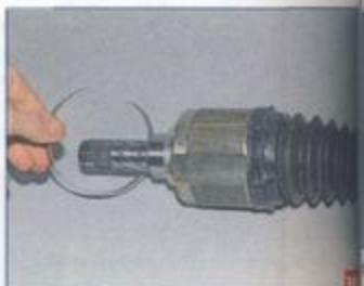
Раскрыв замок хомута, снимаем хомут
