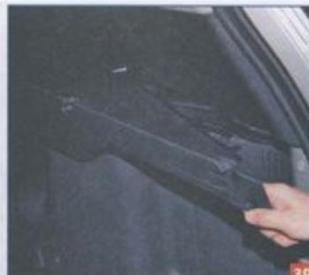
Преодолев сопротивление фиксаторов, сдвигаем полку к середине автомобиля.
