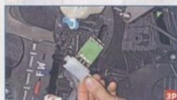
Сдвинув резистор вверх, вынимаем его из корпуса отопителя.
