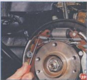
Поддав отверткой, выводим из зацепления с колодкой крючок верхней стяжной пружины...
