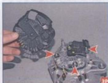
...и снимаем кожух (стрелками показаны шпильки крепления кожуха).
