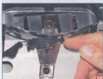
...отжимаем вниз фиксатор патрона...
