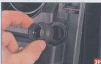
...резиновой уплотнительной втулки в соединении корпуса со штуцером (системы вентиляции картера) крышки головки блока цилиндров.
