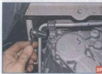
Головкой «на 13» отворачиваем болт крепления держателя трубы гидроусилителя руля к картеру коробки передач.
