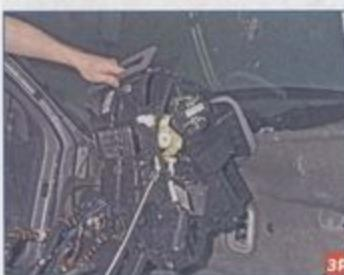
Вынимаем отопитель из салона автомобиля.
