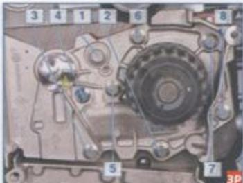
Последовательность затяжки болтов крепления насоса охлаждающей жидкости.
