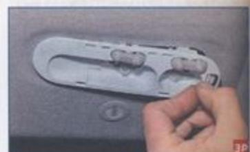
Нажав на пластмассовый фиксатор плафона...
