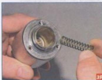
Вынимаем пружину из тягового реле.
