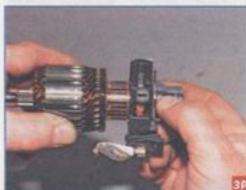
Прижав оправку к коллектору, сдвигаем с нее щеткодержатель на коллектор.
