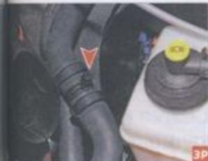
Затвор (для выпуска воздуха из системы охлаждения) на отводящем шланге радиатора стопорителя
