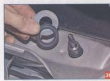
...и снимаем шайбу и уплотнитель с втулки очистителя.
