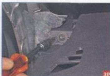
Ключом Torx T-20 отворачиваем винт верхнего бокового крепления панели приборов.
