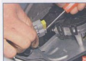
...для наглядности показываем на снятой колодке проводов...
