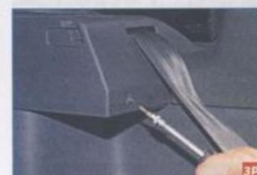
Тем же инструментом отворачиваем саморез переднего крепления полки...
