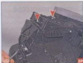
Ключом Торх T-20 отворачиваем три самореза в нижней части отопителя.
