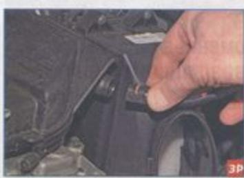
Сжав два фиксатора наконечника трубы, отсоединяем трубку вакуумного усилителя от штуцера ресивера.
