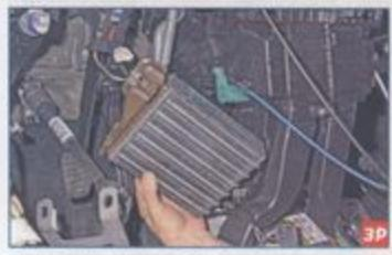
...и вынимаем радиатор из корпуса
