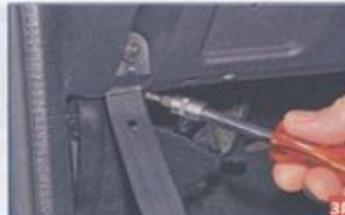
Ключом Torx T-20 отворачиваем винт бокового крепления панели приборов. Аналогично отворачиваем винт с другой стороны панели приборов.
