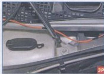
Головкой «на 10» отворачиваем болт крепления бачка омывателя.
