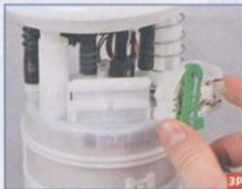
Снимаем датчик указателя уровня топлива.
