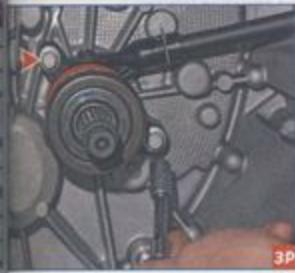
Снимаем рабочий цилиндр с подшипником включения сцепления.
