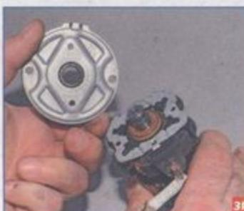
Снимаем заднюю крышку.
