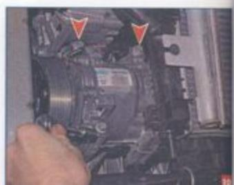
Головкой «на 10» отворачиваем три болта крепления компрессора... ...и располагаем компрессор на подрамнике.
