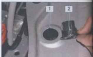
При установке втулки верхней опоры кожуха вентилятора совмещаем ступ 2 на корпусе втулки с пазом в отверстии рамки.
