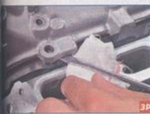
Используя шлицевую отвертку в качестве рычага, поддеваем за приливы крышки головки блока цилиндров...
