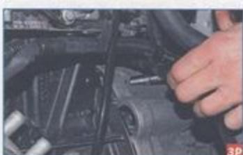
Тем же инструментом отворачиваем передний верхний болт крепления коробки передач к блоку цилиндров двигателя.
