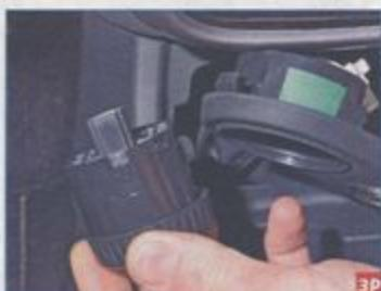
...и вынимаем переключатель из накладки.
