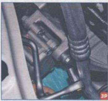
Головкой «на 10» отворачиваем верхний болт крепления насоса к кронштейну двигателя.
