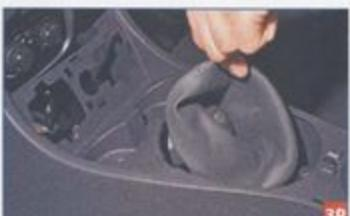
Протолкнув чехол рычага переключения передач в отверстие облицовки...
