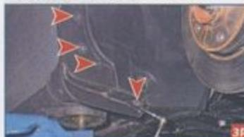
Головкой «на 7» отворачиваем три самореза крепления брызговика к крылу и один – к подкрылку...
