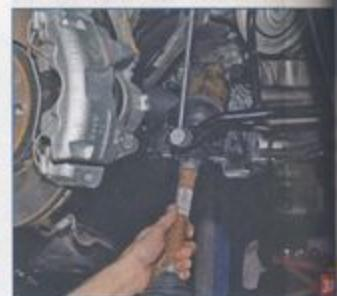
Снимаем привод правого колеса. Устанавливаем приводы передних колес в обратной последовательности. При установке привода правого переднего колеса шлицы проходного вала раздаточной коробки следует смазать пластичной смазкой.
