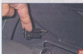
...и вынимаем выключатель из отверстия вещевого ящика.
