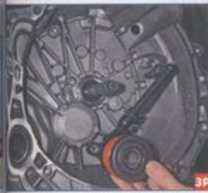
Снимаем рабочий цилиндр с подшипником включения сцепления.
