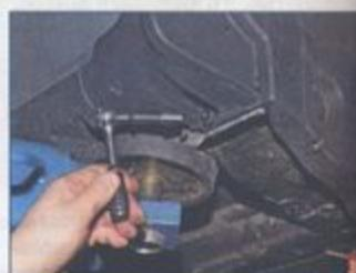
Головкой «на 10» с удлинителем отворачиваем саморез нижнего крепления переднего обвеса порога кузова.
