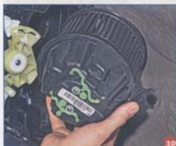
...и вынимаем вентилятор из корпуса отопителя.
