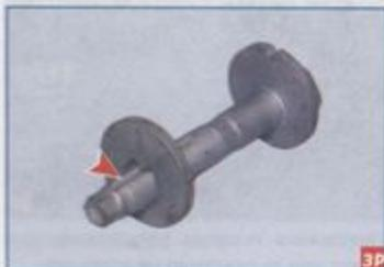
Болт имеет паз для фиксации шайбы в определенном положении.
