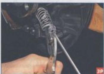
Отсоединяем наконечник троса стояночного тормоза от рычага задней колодки.
