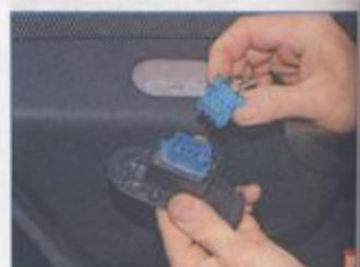
Нажав на фиксаторы колодки жгута проводов, отсоединяем ее от выключателя электростеклоподъемника.
