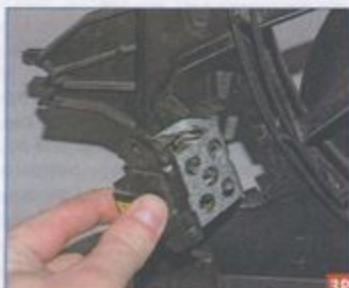
Вынимаем дополнительный резистор вентилятора.
