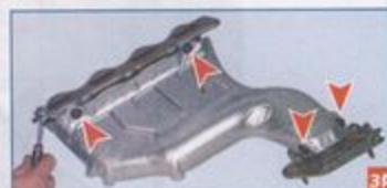
Головкой «на 8» отворачиваем четыре болта крепления нижнего теплоизоляционного экрана к выпускному коллектору...
