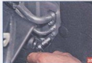
...головкой «на 10» отворачиваем два болта крепления трубок кондиционера к редуктору...
