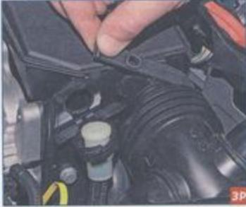
Отсоединяем резиновый хомут крепления резонатора воздушного тракта.
