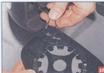
Отсоединяем два наконечника проводов от контактов элемента обогрева...
