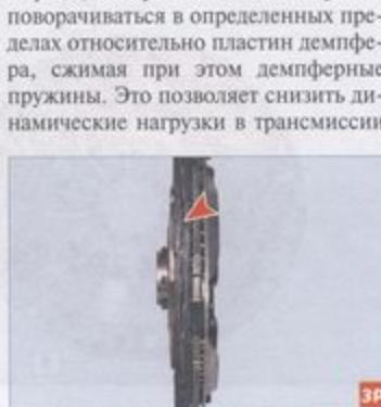
Расположение волнистой пружинной пластины
