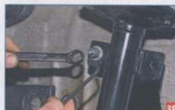
Ключом «на 16» отворачиваем гайку крепления пальца верхнего шарнира стойки стабилизатора к кронштейну амортизаторной стойки, удерживая палец от проворачивания шестигранником «на 5».
