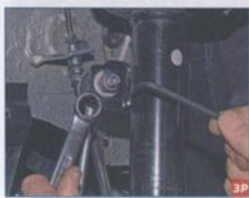
Ключом «на 16» отворачиваем гайку крепления пальца верхнего шарнира
