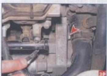
Головкой «на 13» отворачиваем верхний болт крепления стартера.
