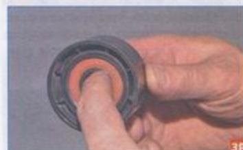
...вращаем ролик, удерживая его за внутреннее кольцо подшипника. Ролик должен вращаться бесшумно, равномерно, без заеданий. В противном случае ролик необходимо заменить. Для замены натяжного ролика...
