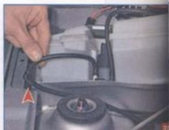
Повернув бачок, выводим шланг из выемки перегородки щитка передка (стрелкой показана выемка).
