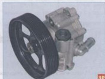
**Насос гидроусилителя рулевого управления**
