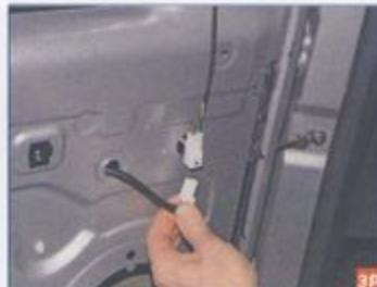
Разъединяем колодки жгутов проводов...
