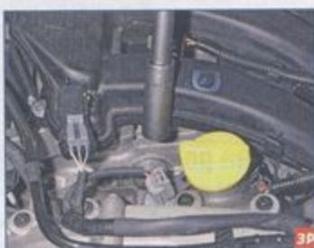
Высокой («свечной») головкой «на 16» с удлинителем выворачиваем свечу зажигания...
