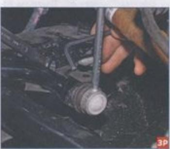
Аналогично отворачиваем гайку крепления пальца нижнего шарнира стойки к штанге стабилизатора...
