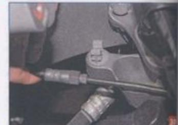
Вынимаем трубку из держателя на кронштейне левой опоры склового агрегата.
