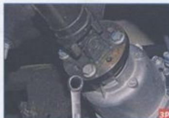
Накидным ключом «на 16» отворачиваем болт крепления вилки шарнира заднего карданного вала к фланцу электромагнитной муфты.
