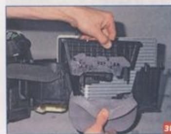
Отклеив поролоновый уплотнитель, снимаем щиток испарителя.
