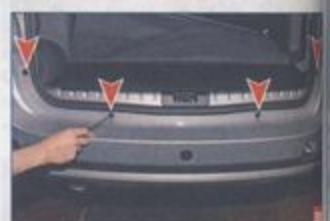
...ключом Torx T-30 отворачиваем че-тыре винта крепления бампера к ку-зову.
