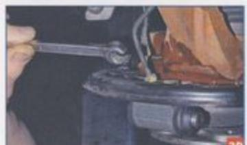
Специальным ключом «на 11» для штуцеров тормозных трубок отворачиваем
