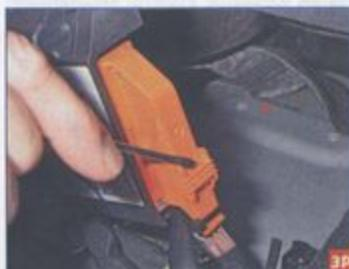
Отверткой нажимаем на фиксатор...
