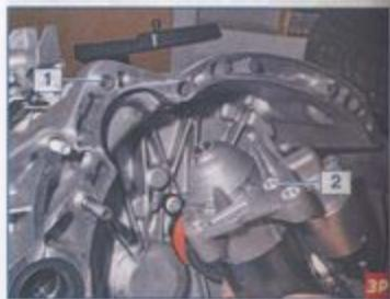
...установочная втулка 1 в картере сцепления должна войти в отверстие 2 передней крышки стартера (для наглядности показано на снятой коробке передач).
