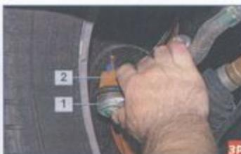
...приложив руку к корпусу шарового шарнира 1 наконечника рулевой тяги и рычагу поворотного кулака 2, оцениваем их взаимное перемещение. Если ощущается свободный ход в шаровом шарнире, необходимо заменить наконечник рулевой тяги. Также нужно заменить наконечник рулевой тяги...
