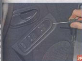
Поддеваем шлицевой отверткой с тонким лезвием блок управления элек-
