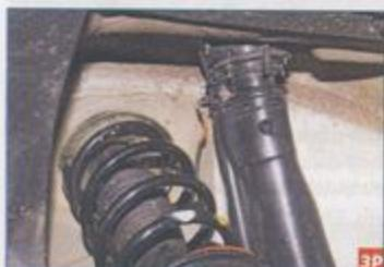
Соединение горловины с наливной трубой в колесной арке правого заднего колеса.
