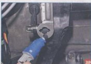
Повернув датчик против часовой стрелки, вынимаем его из отверстия кронштейна педального узла.
