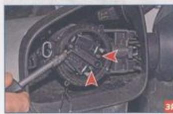
Ключом Торх Т-10 отворачиваем три самореза крепления блока к корпусу зеркала.
