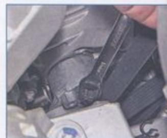
...надеваем накидной ключ «на 16» на шестигранник натяжного устройства...
