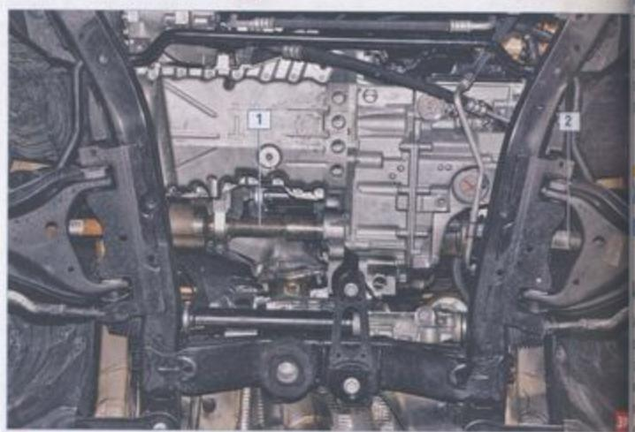
Приводы передних колес на автомобиле 4x2 с автоматической коробкой передач: 1 – привод правого колеса; 2 – привод левого колеса
