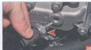
Соединение датчика с корпусом термостата уплотнено алюминиевой шайбой. Устанавливаем датчик температуры охлаждающей жидкости в обратной последовательности. Затягиваем датчик предписанным моментом (см. «Приложения», с. 314). Проверяем и при необходимости доводим до нормы уровень охлаждающей жидкости в расширительном бачке.
