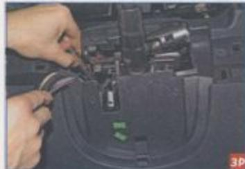
Головкой «на 13» отворачиваем два верхних болта крепления рулевой колонки к кронштейну поперечной балки.
