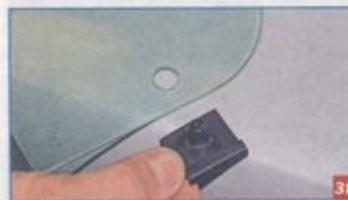
...и вынимаем держатель из отверстия стекла.
