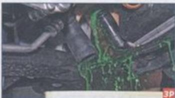
Отсоединяем шланг от патрубка радиатора и сливаем жидкость в подставленную емкость.
