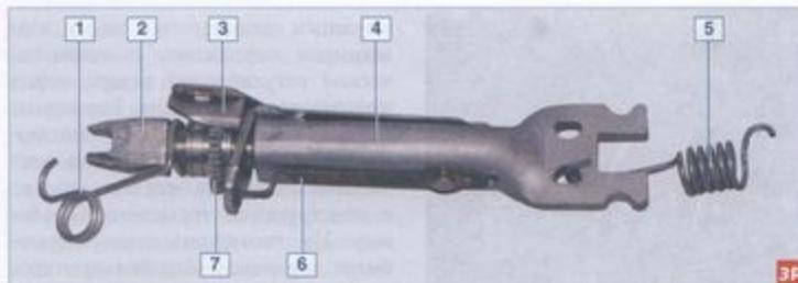
Элементы механизма автоматической регулировки зазора между колодками и барабаном автомобиля 4x4: 1 – витая пружина резьбового наконечника; 2 – резьбовой наконечник распорной планки; 3 – пружинный рычаг регулятора; 4 – распорная планка; 5 – витая пружина распорной планки; 6 – пластинчатая пружина; 7 – храповая гайка
