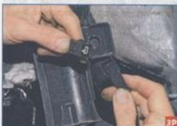
Нажав на фиксатор, отсоединяем колодку заднего жгута проводов от колодки жгута проводов датчика.
