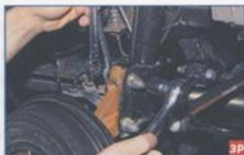
Головкой «на 18» отворачиваем гайку болта верхнего крепления амортизаторной стойки к кулаку задней подвески, удерживая болт ключом того же размера.
