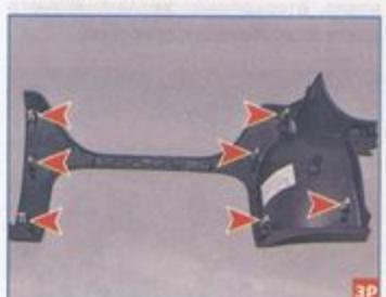
Расположение фиксаторов на правой декоративной накладке панели приборов.
