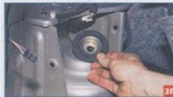
Снимаем резинометаллическую опорную шайбу крепления амортизаторной стойки.
