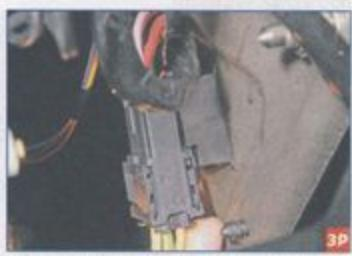
...отжимаем фиксатор держателя колодок проводов выключателя зажигания...
