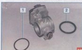
Дроссельный узел с уплотнительными кольцами: 1 – в соединении с ресивером; 2 – в соединении с корпусом воздушного фильтра.
