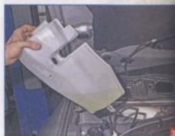
Снимаем бачок омывателя.
