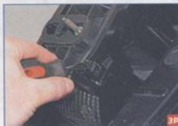
Отверткой отжимаем пять защелок...
