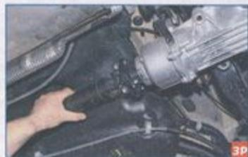
Покачивая относительно друг друга вилки шарнира карданного вала, проверяем наличие люфта в подшипниках крестовин.
