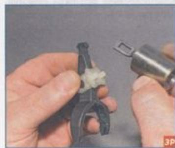
Снимаем якорь тягового реле с рычага привода.
