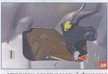
...отжимаем пластмассовый фиксатор (белого цвета) тяги замка на промежуточном рычаге, поворачиваем его вокруг оси и вынимаем конец тяги из отверстия промежуточного рычага.
