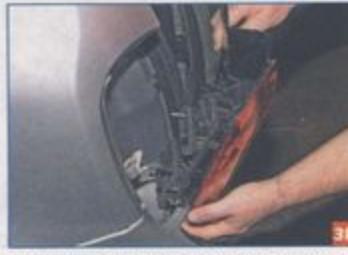
Отводим фонарь от кузова автомобиля.
