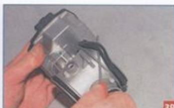
Отверткой поддеваем резиновое кольцо и вынимаем его из проточки патрубка узла.
