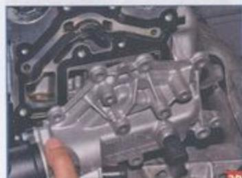
знимаем корпус термостата...
