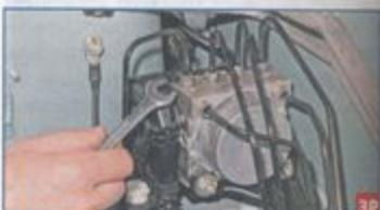
...рожковым ключом «на 11» или специальным ключом для штуцеров тормозных трубок отворачиваем штуцеры шести тормозных трубок и отсоединяем трубы от гидравлического блока.
