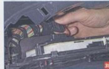
...и, нажав на фиксатор колодки проводов, отсоединяем колодку черного цвета от комбинации приборов.
