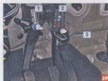
Расположение датчика положения педали сцепления 1, выключателя сигналов торможения 2 и модуля педали «газа» 3 в салоне автомобиля (для наглядности показано при снятой панели приборов и рулевой колонке)
