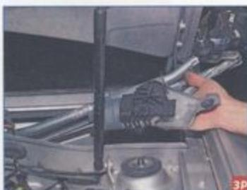
Снимаем очиститель ветрового стекла.
