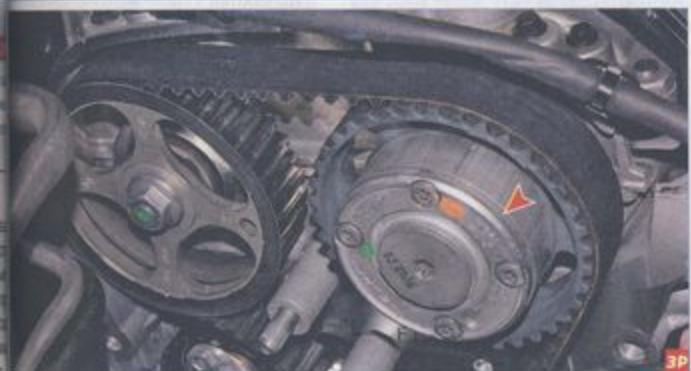
Дополнительный механизм системы изменения фаз газораспределения установлен на носке распределительного вала впускных клапанов и соединен с зубчатым шкивом вала
