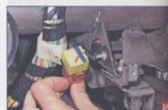
Снимаем реле обогрева стекла двери багажного отделения с держателя на поперечной балке.
