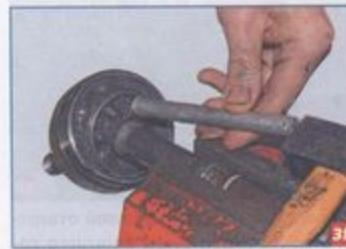
...выколоткой из мягкого металла сбиваем наружный шарнир со шлицев вала.
