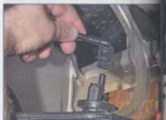
...отсоединяем наконечник трубы от штуцера клапана.
