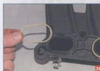
Аналогично вынимаем из пазов фланца ресивера четыре уплотнительные прокладки в соединении с впускным трубопроводом.
