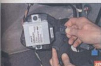
Нажав на фиксатор колодки проводов, отсоединяем колодку от разъема блока.
