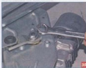
Накидным ключом «на 13» отворачиваем гайку крепления кривошипа.
