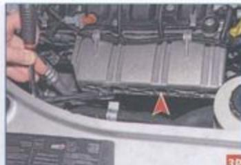
Через каналы в защите головки «на 13» с удлинителем отворачиваем две гайки шпилек крепления защиты рампы.
