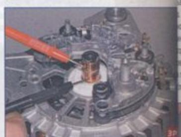
...подсоединяя щупы цифрового тестера (в режиме омметра) к контактным колышкам.
