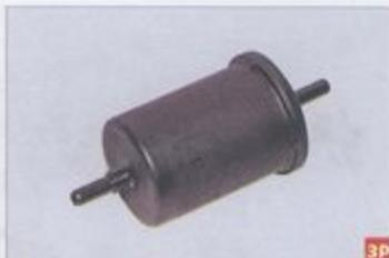
Сменный топливный фильтр автомобиля с двигателем 2,0
