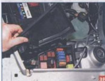
...снимаем крышку монтажного блока. Неисправный предохранитель определяем по перегоревшей перемычке. Для извлечения предохранителя малого размера...
