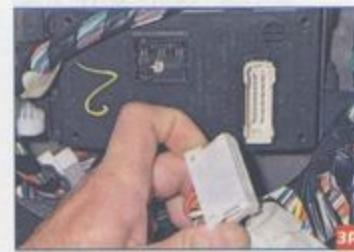
Сжав два фиксатора колодки проводов, отсоединяем колодку белого цвета от разъема блока.
