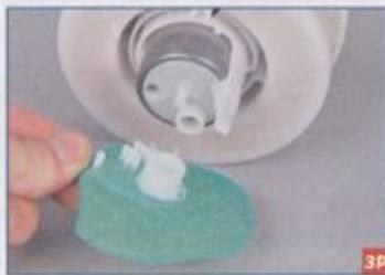
Потянув, снимаем со штуцера топливного насоса сетчатый фильтр. Теперь его можно промыть или заменить.
