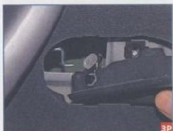
...и вынимаем ее из обивки двери, выводя тягу из отверстия рычага ручки.
