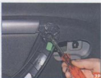
Ключом Torx T-30 отворачиваем саморез крепления ручки к двери.
