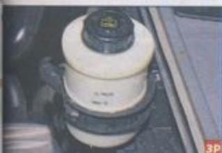
На корпусе бачка нанесены метки MINI и MAXI, между которыми должен находиться уровень рабочей жидкости при холодном двигателе.
