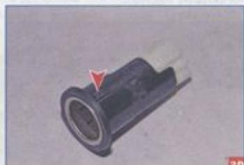
Прикуриватель (стрелкой показан фиксатор прикуривателя, второй фиксатор на фото не виден).
