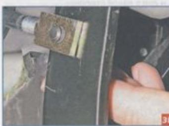
Отводим от педали тормоза пружинный фиксатор пальца крепления толкателя вакуумного усилителя к педали...
