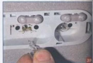
Вынимаем лампу освещения салона. Устанавливаем новую лампу W5W в обратной последовательности.
