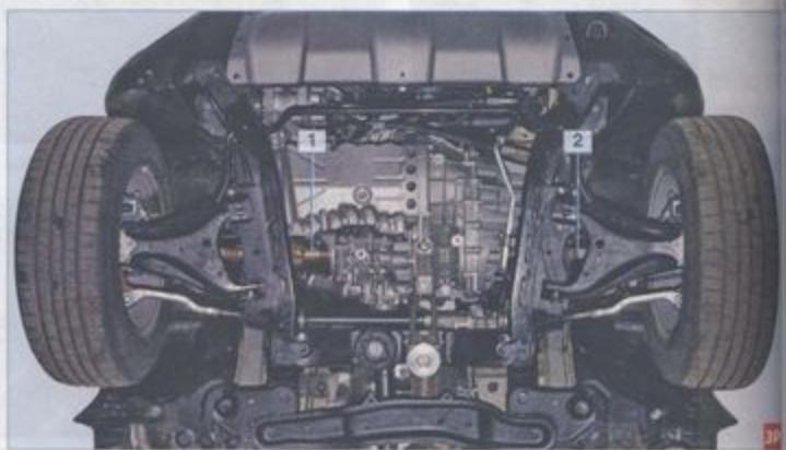
**Приводы передних колес на автомобиле 4×4:** 1 – привод правого колеса; 2 – привод левого колеса
