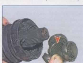
Снимаем трехшпилевик с вала.
