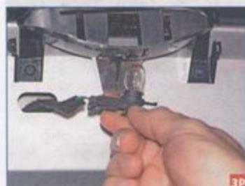
Вынимаем патрон с лампой из корпуса сигнала.
