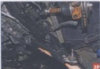
Снимаем рычаг подвески.
