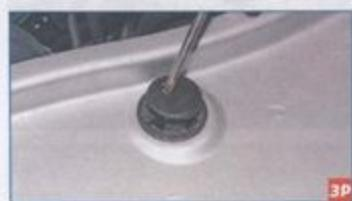
Отверткой освобождаем фиксатор верхней опоры кожуха вентилятора...
