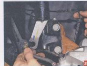
Выводим резиновые муфты жгута проводов датчика скорости вращения переднего колеса и тормозного шланга из кронштейна амортизаторной стойки.
