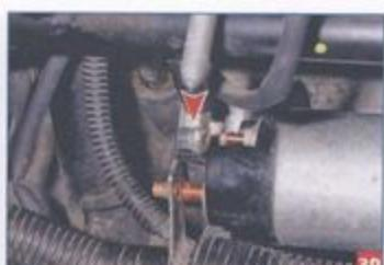
Гайка закреплена на наконечнике провода.
