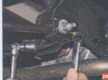
Накидным ключом «на 21» отворачиваем гайку регулировочного болта крепления рычага к подрамнику, удерживая регулировочный болт от проворачивания головкой того же размера.
