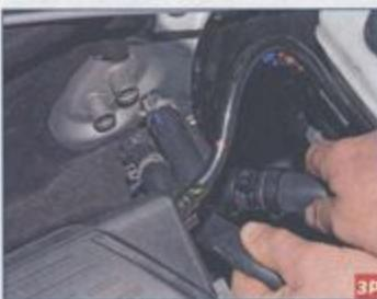
...и отсоединяем подводящий и отводящий шланги отопителя от трубок радиатора отопителя.
