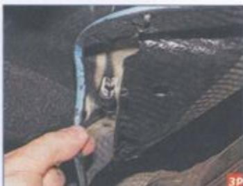
Вынимаем жгут проводов датчика из держателя, закрепленного на кузове.
