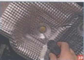
Крестообразной отверткой выворачиваем на несколько оборотов фиксатор пистона...
