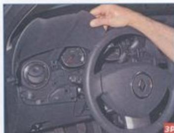
...и снимаем накладку, выводя два направляющих штифта накладки из отверстий левой и правой декоративных накладок.
