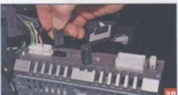
Нажав на фиксатор колодки проводов, отсоединяем колодку черного цвета (колодка пульта дистанционного управления аудиосистемой) от разъема головного устройства.
