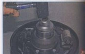
...и, нанося удары молотком по торцу внутреннего кольца подшипника через оправку или головку подходящего размера, выпрессовываем подшипник из кулака.
