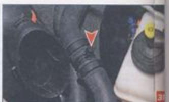
...и колпачок штуцера (выпуска воздуха из системы охлаждения), расположенного на шланге отвода жидкости из радиатора отопителя (резонатор воздушного тракта для наглядности снят).
