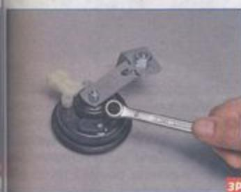
...накидным ключом «на 10» отворачиваем гайку крепления сигнала.
