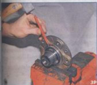
Нанося удары молотком по зубилу, сдвигаем внутреннее кольцо подшипника по ступице.
