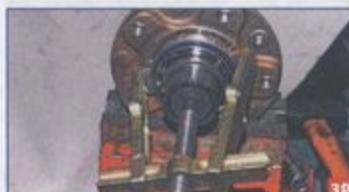
Засцепляем лапы двухзахватного съемника за внутреннее кольцо подшипника и окончательно спрессовываем внутреннее кольцо подшипника со ступицы.
