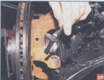
Снимаем датчик скорости вращения переднего колеса (см. «Снятие датчи-
