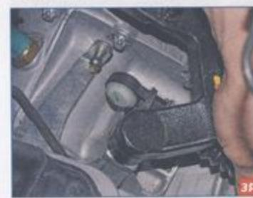
...и снимаем наконечник троса с шарошальной пальца рычага включения передач. Снизу автомобиля отворачиваем болты крепления кронштейна промежуточной опоры карданной передачи к днищу кузова и отсоединяем вилку шарнира переднего карданного вала от фланца выходного вала раздаточной коробки (см. «Снятие карданной передачи», с. 166) и отводим карданный вал в сторону.
