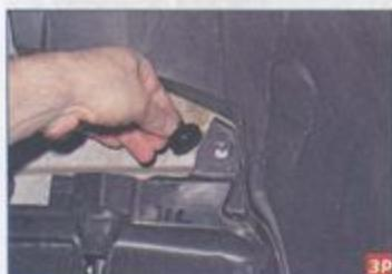
Отворачиваем пластмассовую гайку верхнего крепления грязезащитного щитка к кузову.
