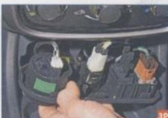
...и выводим ее из облицовки туннеля пола, преодолевая сопротивление восьми фиксаторов.
