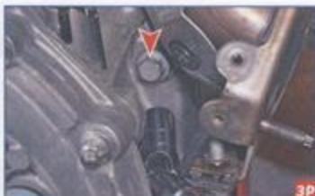
Со стороны фланца картера сцепления головкой «на 13» с карданным шарниром и удлинителем отворачиваем верхний болт крепления раздаточной коробки к картеру сцепления (для наглядности показано на снятом двигателе).
