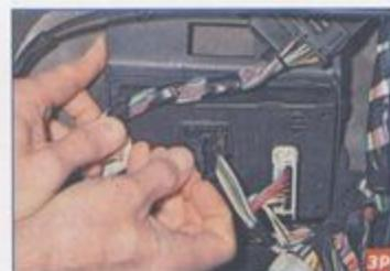
Нажимаем на фиксатор колодки проводов...
