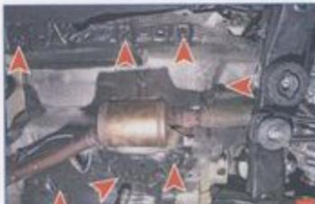
Головкой «на 24» отворачиваем семь гаек шпилек крепления теплозащитного экрана каталитического нейтрализатора к днищу кузова...
