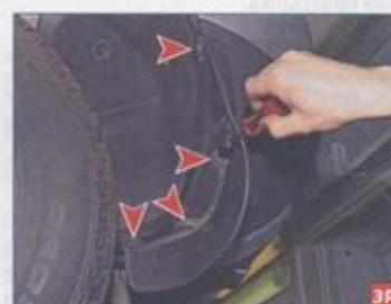
...головкой «на 7» отворачиваем четыре самореза крепления брызговика к бамперу...
