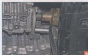
При снятии привода правого колеса монтажную лопатку опираем на труб-
