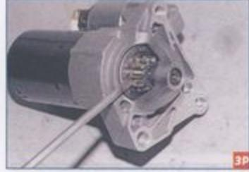
Отверткой сдвигаем шестернию по валу.
