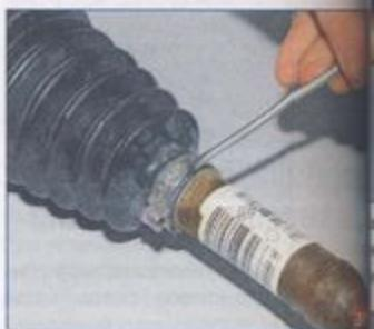
Отверткой раскрываем замок малого хомута...
