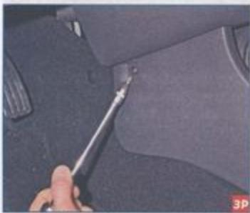
Ключом Торх Т-20 отворачиваем с каждой стороны по одному саморезу бокового крепления облицовки туннеля пола.
