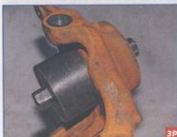
Чашечным съемником выпрессовываем подшипник из поворотного кулака. Подшипник также можно выпрессовать ударным способом.
