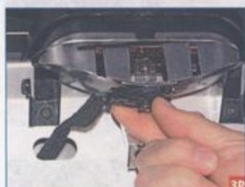
...и поворачиваем патрон лампы по часовой стрелке.
