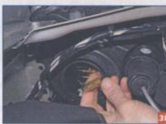
Потянув, вынимаем патрон с лампой из корпуса блок-фары.
