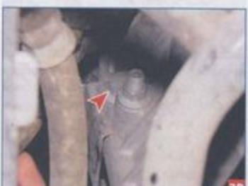
Тем же инструментом отворачиваем нижний болт крепления стартера (для наглядности показан снизу автомобиля).
