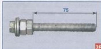
На болт наворачиваем две регулировочные гайки и законтриваем их так, чтобы длина резьбовой части болта была равна 75 мм.
