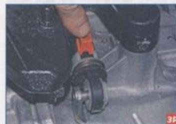
Надеваем пластмассовую головку наконечника троса на шаровой палец рычага выбора коробки передач и нажимаем на фиксатор (как показано на фото), после чего запираем фиксатор втулкой. Соединяем трос включения передач, не имеющий регулировки по длине, с рычагом включения передач на коробке.
