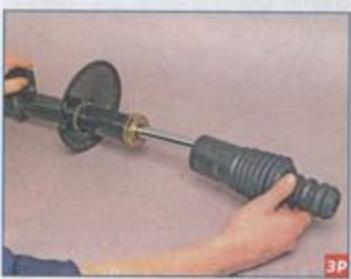
...и буфер хода сжатия с защитным чехлом.
