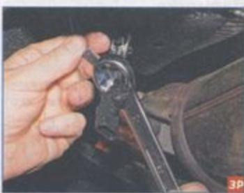
Продеваем через кольцо накидного ключа «на 22» колодку жгута проводов датчика...
