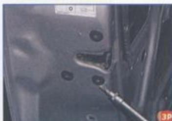
Ключом Торх Т-30 отворачиваем три винта крепления замка к торцу двери...
