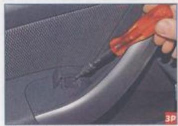
Ключом Torx T-20 отворачиваем саморез крепления подлокотника к кронштейну внутренней панели двери.
