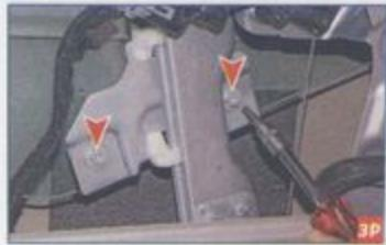
Ключом Торх Т-20 отворачиваем два самореза крепления держателей стекла к ползуну стеклоподъемника.
