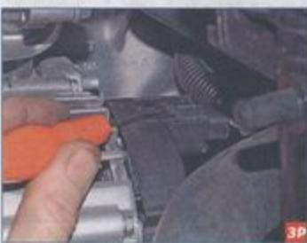
Отверткой отжимаем фиксатор колодки проводов...
