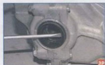
Поддеваем отверткой сальник привода...
