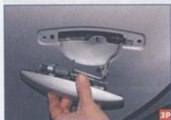
Снимаем наружную ручку задней двери вместе с тягой.
