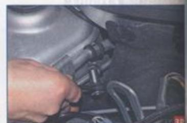
Тем же инструментом отворачиваем гайку крепления держателей трубок кондиционера на чашке брызговика.
