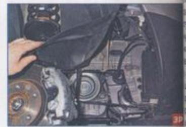
Отгибаем переднюю часть подкрылья и заводим ее за тормозной диск.
