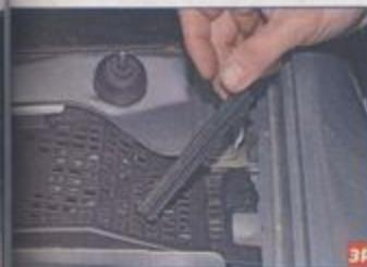
снимаем уплотнитель с брызговика второго отсека.
