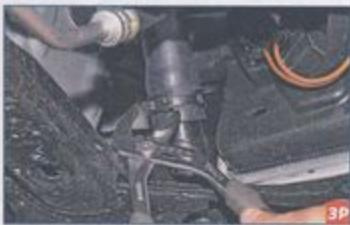
...раздвижными пассатижами сжимаем концы хомута крепления шланга к нижнему патрубку радиатора и сдвигаем хомут по шлангу.
