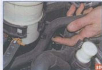
Аналогично вынимаем шланг бачка гидроусилителя рулевого управления из другого держателя на кожухе вентилятора.
