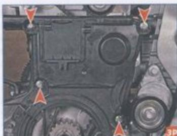
Головкой «на 8» отворачиваем четыре болта крепления нижней крышки привода ГРМ...
