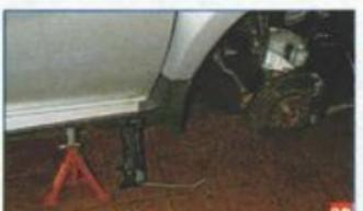
Не работайте под автомобилем, если он выведен только на домкрате. Для страховки используйте опорную стойку заводского изготовления.
