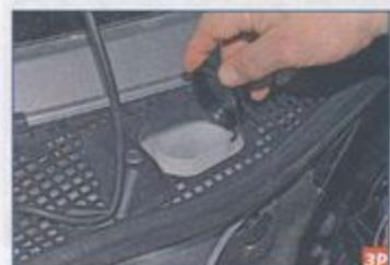
Открываем крышку заливной горловины бачка.
