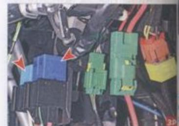
Реле электрообогревателя салона (для наглядности показано при снятой панели приборов)
