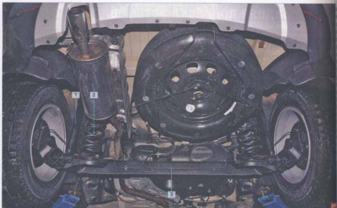
**Задняя подвеска:** 1 – амортизатор; 2 – пружина; 3 – балка задней подвески
