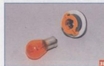
...и вынимаем лампу из патрона. Устанавливаем новую лампу PY21W в обратной последовательности. При этом...
