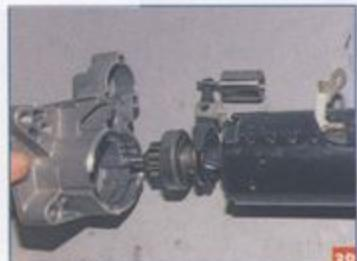
...и снимаем переднюю крышку.
