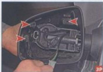
Сжимаем три пары фиксаторов облицовки...
