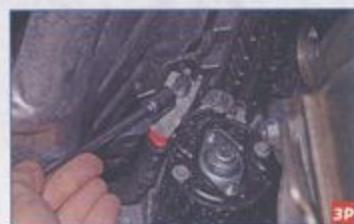
Головкой «на 10» отворачиваем гайку крепления наконечника провода, соединенного с «плюсовым» выводом аккумуляторной батареи. Гайка закреплена на наконечнике провода.
