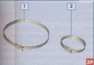
Универсальные ленточные хомуты для крепления чехла ШРУСа: 1 – хомут крепления чехла на корпусе шарнира; 2 – хомут крепления чехла на валу привода
