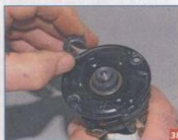
Вынимаем из проточки вала якоря стопорную шайбу.
