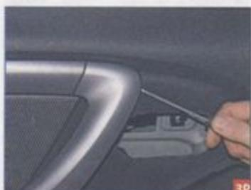
Поддеваем шлицевой отверткой с тонким лезвием декоративную облицовку ручки двери...
