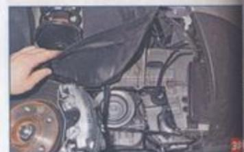
Отгибаем переднюю часть подкрылья и заводим ее за тормозной диск.
