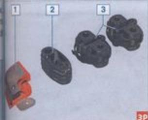
Подушки подвески системы выпуска отработавших газов автомобиля 4x4: 1 — подушка подвески каталитического нейтрализатора; 2 — подушка подвески трубы дополнительного глушителя; 3 — подушки подвески основного глушителя
