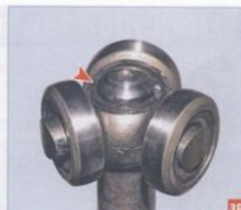
Трехшпиников зафиксирован на валу привода стопорным кольцом
