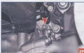
Головкой «на 13» с удлинителем отворачиваем верхнюю гайку шпильки крепления раздаточной коробки к картеру сцепления.
