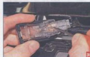
Шлицевой отверткой поддеваем лампу...
