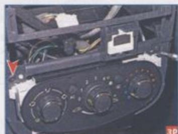
Ключом Торх T-20 отворачиваем два самореза крепления блока управления.
