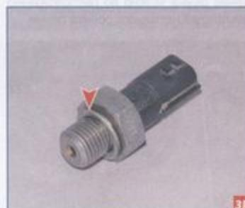
Соединение датчика с блоком цилиндров уплотняется кольцом из мягкого металла.
