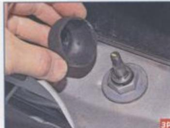
Снимаем защитный колпак с гайки очистителя.
