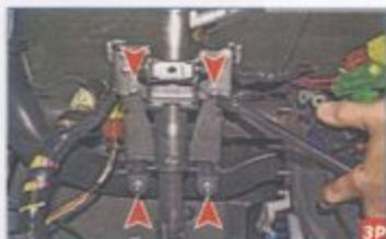
Головкой «на 13» отворачиваем четыре болта крепления рулевой колонки к кронштейну поперечной балки, расположенной под панелью приборов.
