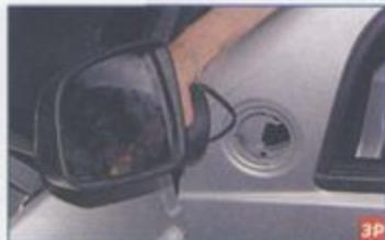
...и снимаем наружное зеркало. Устанавливаем наружное зеркало в обратной последовательности.
