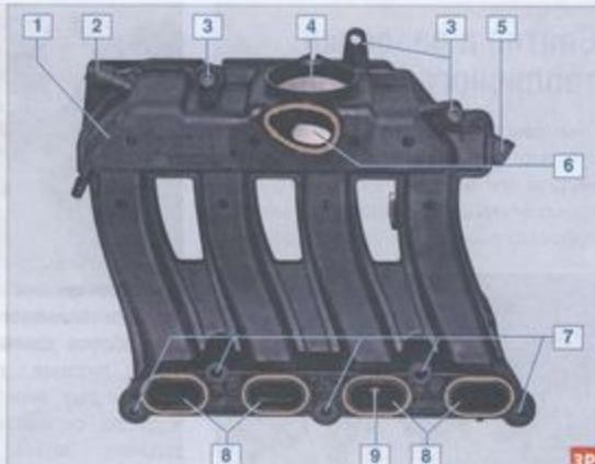
Ресивер двигателя 2,0: 1 – корпус; 2 – штуцер для присоединения трубы вакуумного усилителя тормозов; 3 – отверстия заднего крепления ресивера; 4 – отверстие для соединения с патрубком дроссельного узла; 5 – датчик абсолютного давления воздуха; 6 – отверстие, неиспользуемое в данной конструкции двигателя; 7 – отверстия переднего крепления ресивера; 8 – каналы подвода воздуха к цилиндрам; 9 – датчик температуры воздуха на впуске
