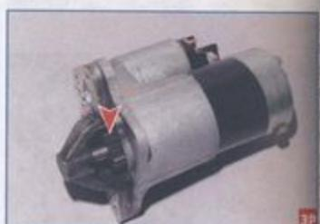
...отверткой проворачиваем шестерню привода.
