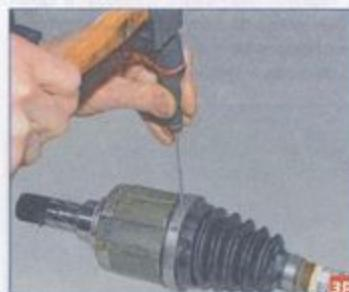
Расположив лезвие шлицевой отвертки в месте стыка замка большого хомута, наносим удары молотком по рукоятке отвертки.
