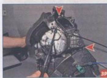
Тем же инструментом отворачиваем два самореза с левой стороны отопителя...
