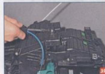
...и саморез в передней части отопителя.
