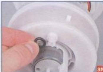
Соединение канала регулятора давления топлива уплотнено резиновым кольцом.
