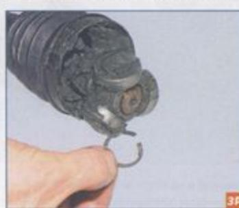
...вынимаем его из проточки на валу.
