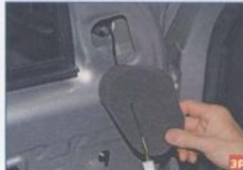
Вынимаем поролоновый уплотнитель из отверстия в двери и вытаскиваем через него жгут проводов.
