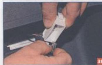
Вынимаем лампу из плафона.
