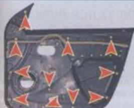
Расположение пистонов с внутренней стороны обивки передней двери. Сорванные пистоны заменяем новыми. Устанавливаем обивку передней двери обратной последовательности.
