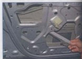
Выводим направляющую через технологическое отверстие во внутренней панели двери...
