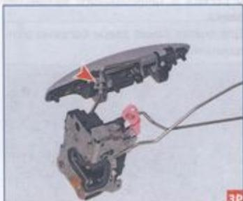
После установки наружной ручки и замка, тяга ручки защелкивается в требуемом положении металлическим фиксатором, при этом рычаги замка и ручки должны находиться в свободном положении.
