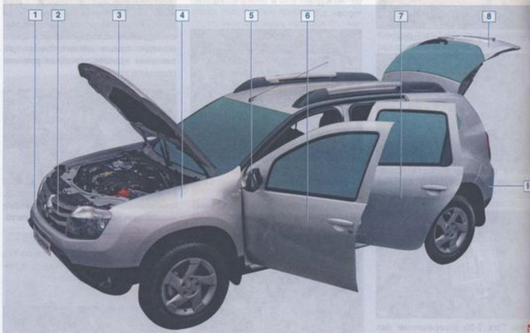
**Съемные элементы кузова:** 1 – передний бампер; 2 – облицовка радиатора; 3 – капот; 4 – переднее крыло; 5 – наружное зеркало заднего вида; 6 – передняя дверь; 7 – задняя дверь; 8 – дверь багажного отделения; 9 – задний бампер
