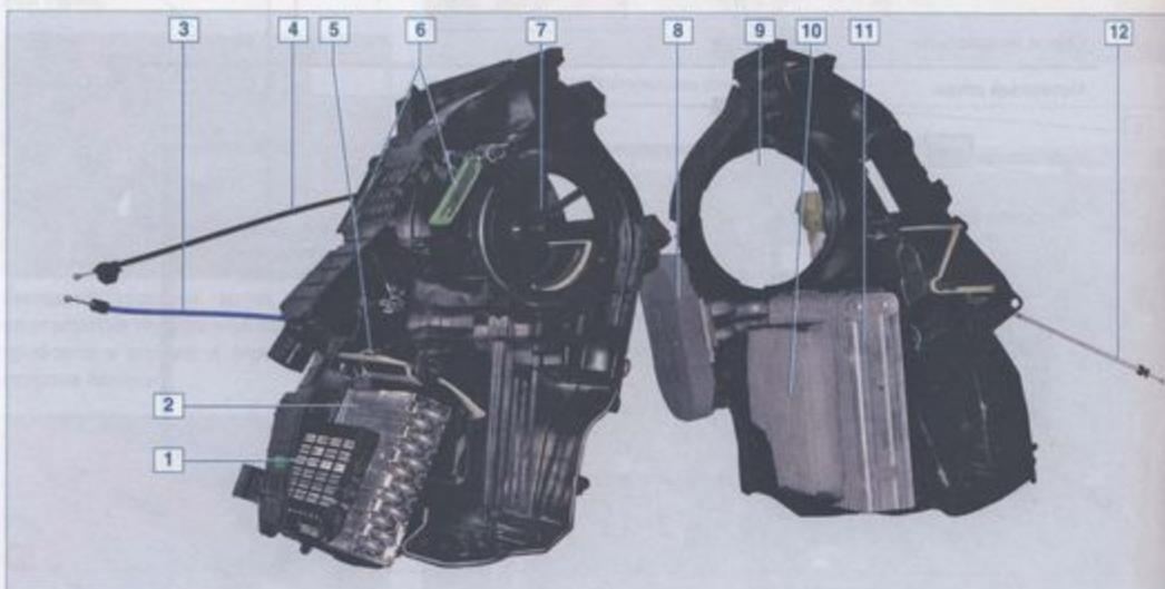
**Элементы отопителя (для наглядности показано на разобранном пополам корпусе отопителя):** 1 – дополнительный электрообогреватель салона; 2 – радиатор отопителя; 3 – тяга заслонки регулятора температуры; 4 – тяга заслонки рециркуляции; 5 – заслонка регулятора температуры; 6 – распределительная заслонка; 7 – заслонка рециркуляции; 8 – уплотнитель; 9 – гнездо вентилятора; 10 – салонный фильтр; 11 – испаритель кондиционера; 12 – тяга распределительных заслонок
