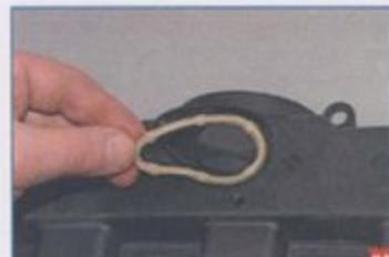
Для замены прокладки в соединении с крышкой маслоотделителя вынимаем ее из пазов ресивера.
