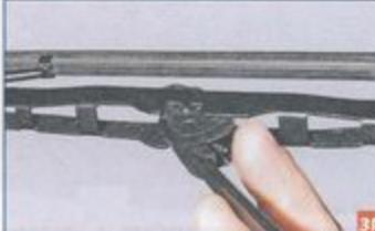
...нажимаем язычок фиксатора щетки...
