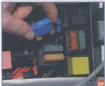
Предохранители большого размера вынимаем рукой. В случае затруднения аккуратно вынимаем предохранители пассатижами.
