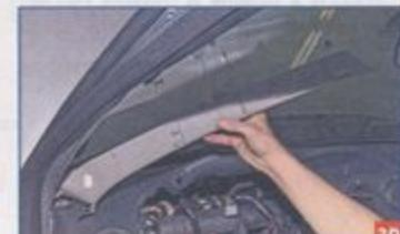
...выводим нижние фиксаторы из отверстий в панели приборов и снимаем обивку левой передней стойки.
