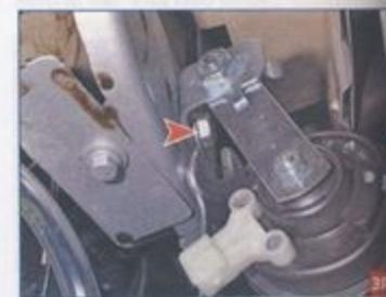
Ключом «на 13» отворачиваем болт крепления кронштейна сигнала.
