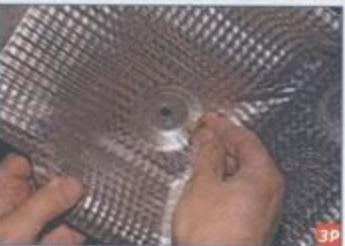
...и, поддав шлицевой отверткой, извлекаем пистон.
