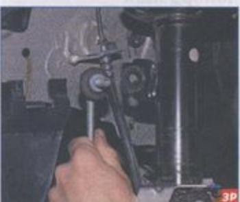
Выводим палец верхнего шарнира стойки стабилизатора из отверстия кронштейна амортизаторной стойки.
