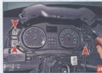
Ключом Torx T-20 отворачиваем четыре самореза крепления комбинации приборов.
