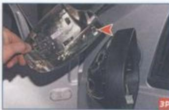
...и снимаем облицовку, преодолевая сопротивление еще двух фиксаторов (показаны стрелкой).
