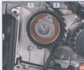
При нормальном натяжении ремня подвижный указатель 1 должен совпадать с выемкой неподвижного указателя 2 натяжного ролика (для наглядности показано при снятой нижней крышке привода ГРМ).
