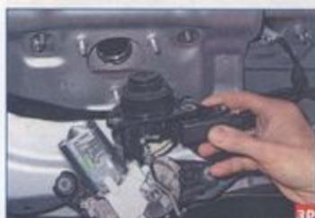
...и снимаем его со шпилек двери вместе с электроприводом блокировки замка.
