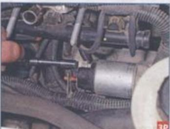
Головкой «на 8» отворачиваем гайку...
