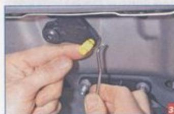
...отжимаем пластмассовый фиксатор (желтого цвета) тяги цилиндрового механизма замка на промежуточном рычаге, поворачиваем его вокруг оси и вынимаем конец тяги из отверстия промежуточного рычага.
