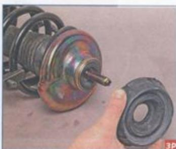
Снимаем опору стойки...
