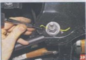
...кернером помечаем положение эксцентриковой шайбы относительно подрамника, чтобы при последующей сборке можно было приблизительно сохранить углы установки колес.
