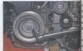
Головкой «на 18» отворачиваем болт крепления шкива привода вспомогательных агрегатов и снимаем болт с шайбой.
