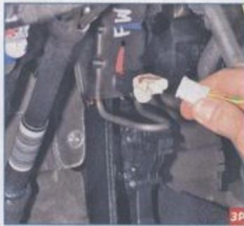
...отсоединяем колодку от разъема выключателя сигналов торможения.
