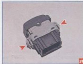
Выключатель центрального замка (стрелками показаны фиксаторы выключателя).
