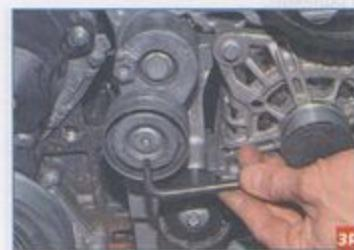
...ключом Torx T-40 отворачиваем винт крепления ролика (для наглядности показано на снятом двигателе).
