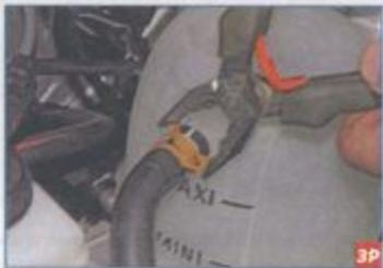
Пассатижами сжимаем концы хомута крепления пароотводящего шланга и, сдвинув хомут по шлангу...
