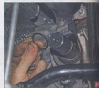
Уплотнительное кольцо, надетое на проходной вал раздаточной коробки, следует заменить, если оно повреждено или потеряло эластичность.
