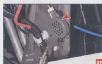
Ключом Torx T-20 отворачиваем два винта пистонов крепления зуммера (динамика) парктроника и вынимаем пистоны.
