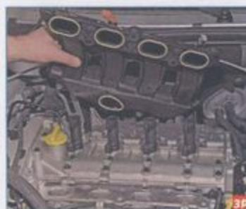
Снимаем ресивер в сборе с датчиками температуры и абсолютного давления воздуха.
