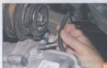
Вынимаем жгут проводов из пластмассового держателя, установленного на кронштейне передних опор редуктора.
