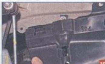
Сдвинув щиток вниз, выводим фиксирующий лепесток щитка из под отборовки брызговика кузова...
