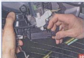
Отжав фиксатор колодки жгута проводов...
