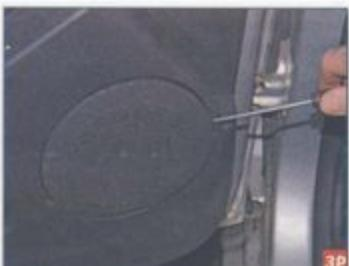
Поддеваем шлицевой отверткой с тонким лезвием крышку динамика...
