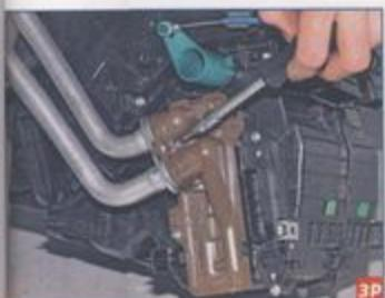
Ключом Торх T-20 отворачиваем винт...
