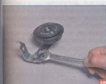
...ключом «на 13» отворачиваем болт крепления пластины сигнала.
