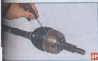
Всплюжив лезвие шлицевой отвертки в месте стыка замка большого хомута, наносим удары молотком по рукоятке отвертки.
