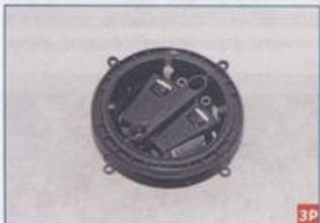
...и снимаем блок мотор-редукторов. Устанавливаем блок мотор-редукторов в обратной последовательности.
