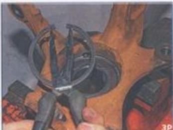
Щипцами для снятия стопорных колец или пассатижами с тонкими губками вынимаем стопорное кольцо подшипника из канавки поворотного кулака.
