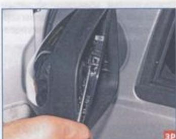
Отверткой отжимаем фиксатор отражающего элемента...
