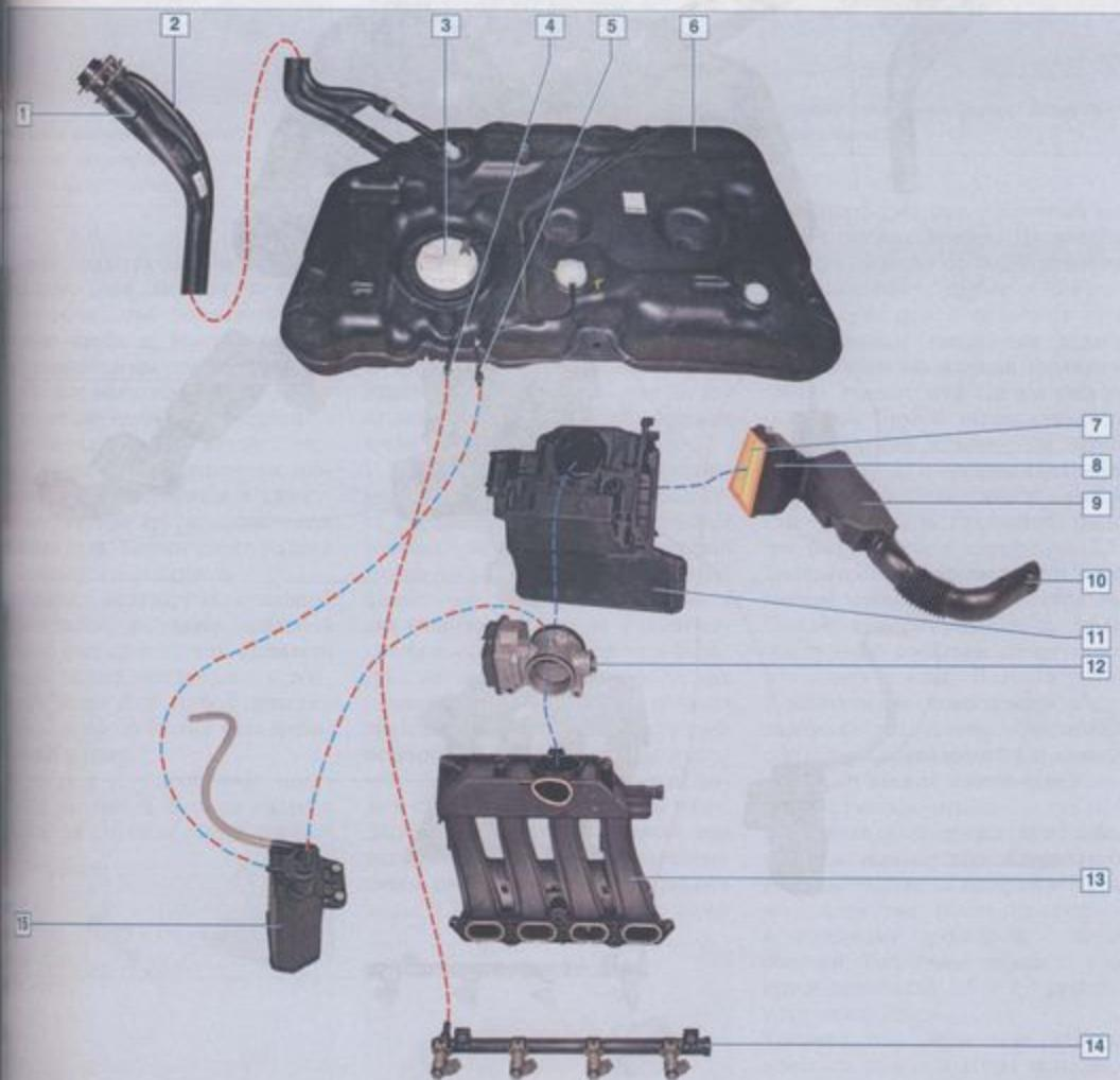
Элементы системы питания автомобиля с двигателем 1,6: 1 – наливная труба топливного бака; 2 – вентиляционная трубка топливного бака; 3 – топливный модуль; 4 – трубка подачи топлива к рампе; 5 – трубка подвода паров топлива к адсорберу; 6 – топливный бак; 7 – сменный элемент воздушного фильтра; 8 – крышка воздушного фильтра; 9 – резонатор впускного тракта; 10 – воздухозаборник; 11 – корпус воздушного фильтра; 12 – дроссельный узел; 13 – расивер; 14 – топливная рампа с форсунками; 15 – адсорбер
