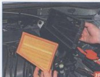
Вынимаем сменный элемент из крышки.
