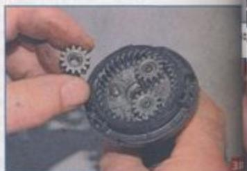
Вынимаем три сателлита планетарного редуктора.
