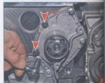
Головкой «на 8» отворачиваем два болта крепления насоса к блоку цилиндров.
