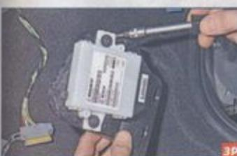
Ключом Торх T-20 отворачиваем два самореза крепления блока...
