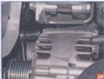
Головкой «на 10» отворачиваем верхний болт крепления генератора.
