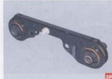
Кронштейн переднего крепления редуктора с двумя опорами
