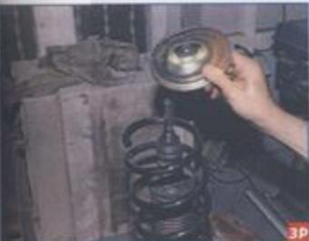
...и верхнюю опорную чашку пружины.
