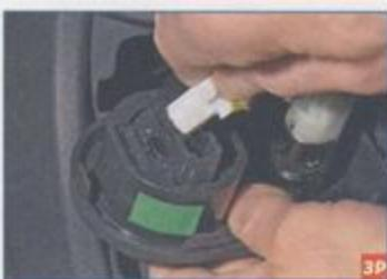
Нажав на фиксатор колодки проводов, отсоединяем колодку от переключателя режимов трансмиссии.
