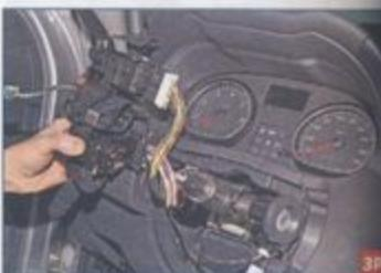
Сдвигаем соединитель переключателя с рулевой колонки.
