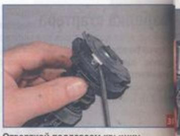
Отверткой поддеваем крышку...
