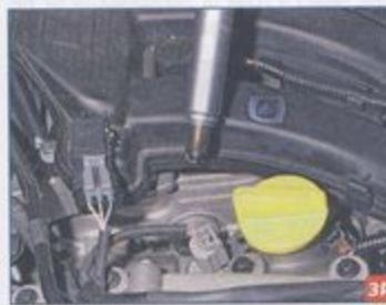
...и вынимаем ее из свечного колодца. Устанавливаем новую свечу в обратной последовательности.
