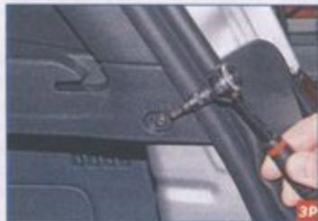
Ключом Torx T-20 отворачиваем саморез заднего крепления правой полки багажного отделения.
