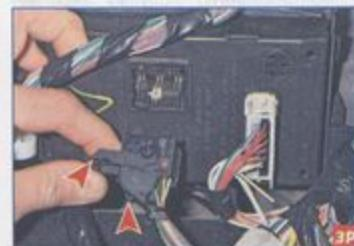
...и, повернув скобу фиксатора, отсоединяем колодку черного цвета от разъема блока (стрелками показаны скоба и фиксатор).
