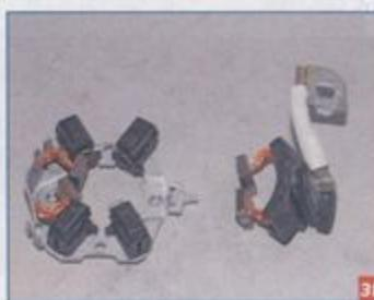
Снимаем изолированные щетки со щеткодержателя.
