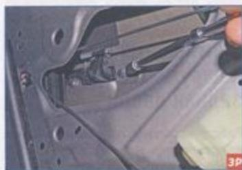
Головкой «на 10» с удлинителем отворачиваем гайку крепления наружной ручки двери.
