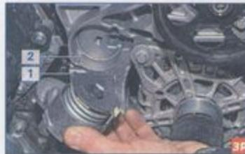
Снимаем натяжное устройство в сборе с роликом.
