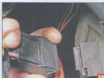
Нажав на фиксатор колодки проводов, отсоединяем колодку от катушки иммобилайзера (для наглядности подрулевые переключатели сняты).
