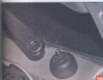
и снимаем рычаг со щеткой с вала очистителя.
