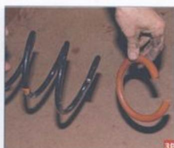
Снимаем виброшумопоглощающий чехол пружины.
