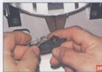
Потянув лампу, вынимаем ее из патрона.
