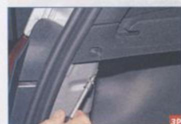
Ключом Torg T-20 отворачиваем саморез заднего крепления левой полки багажного отделения.
