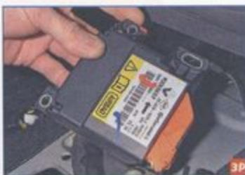
Выводим блок управления из-под консоли панели приборов.
