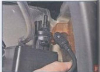
Аналогично отсоединяем от штуцера адсорбера наконечник трубы, соединяющей адсорбер с топливным баком.
