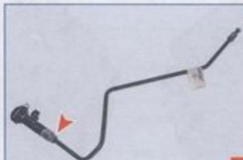
...специальным ключом «на 10» отворачиваем штуцер трубы, удерживая наконечник ключом «на 14».
