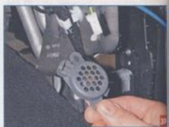
...отсоединяя колодку и снимаем зуммер парктроника.
