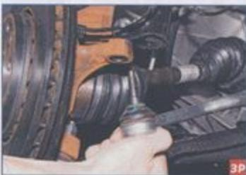
Отсоединяем наконечник рулевой тяги от поворотного кулака (см. «Замена наконечника рулевой тяги», с. 208).
