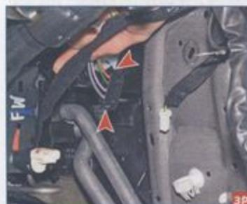
Сжав два фиксатора колодки проводов (показаны стрелками), отсоединяя колодку от дополнительного резистора.
