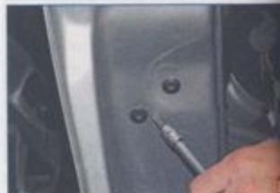
Ключом Торх Т-30 отворачиваем винта крепления направляющей стяжки к торцу двери.
