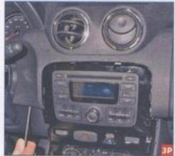
Поддеваем отверткой правую декоративную накладку панели приборов...
