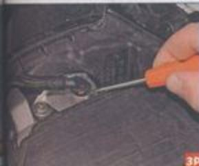
С помощью шлицевой отвертки наконечник трубы подвода паров топлива снимаем с дроссельному узлу...
