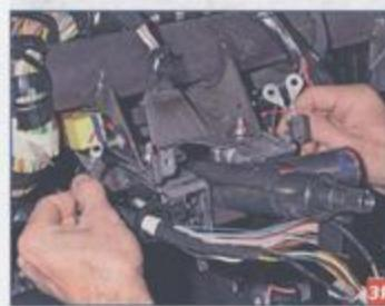
...и снимаем со шпилек наконечники «массовых» проводов.
