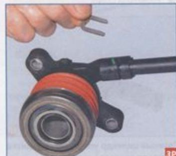
...и вынимаем фиксатор трубки.
