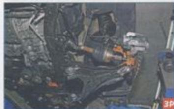
Отворачиваем гайки болтов крепления рычага передней подвески к подрамнику и вынимаем болты (см. «Снятие рычага и шаровой опоры», с. 182).
