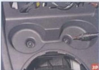
Ключом Торх Т-20 отворачиваем два самореза крепления передней части облицовки туннеля пола в передней нише для стаканов.
