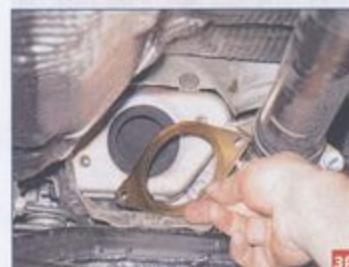
Снимаем со шпилек выпускного коллектора металлическую многослойную прокладку.
