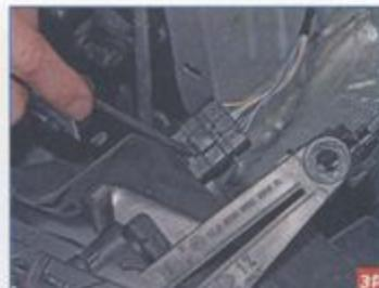
Отверткой поддеваем фиксатор колодки проводов...
