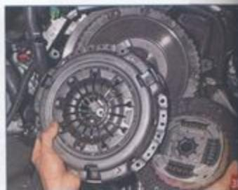
Снимаем «корзину» и ведомый диск сцепления.
