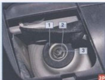
Крепление амортизаторной стойки к кузову: 1 – резинометаллическая опорная шайба; 2 – гайка; 3 – шток амортизатора.
