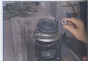
...и снимаем гайку.
