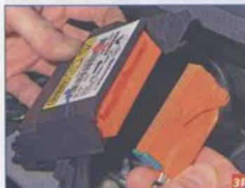
...и, повернув запорную скобу колодки проводов, отсоединяем колодку от разъема блока...
