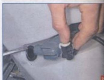
...и, поддев насос отверткой, вынимаем его из бачка.
