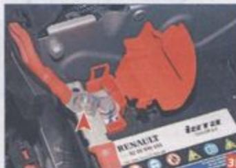
...и, открыв крышку, ключом «на 10» отворачиваем гайку...
