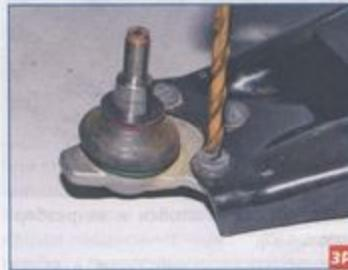
...высверливаем головки заклепок, крепящих корпус шаровой опоры к рычагу.
