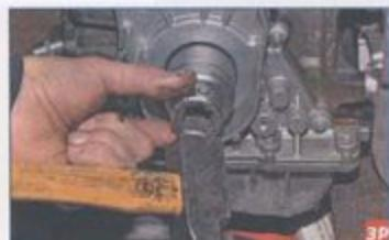
...запрессовываем сальник в гнездо с помощью инструментальной головки или отрезка трубы подходящего размера.
