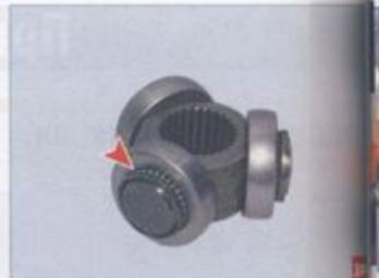
Игольчатый подшипник фиксируется от смещений вдоль оси шипа запорным кольцом, надетым на стопорное кольцо, расположенное в проточке шипа
