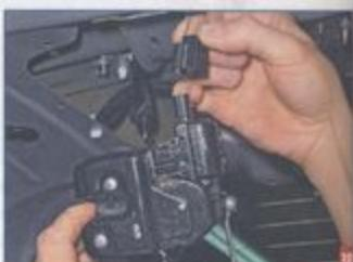
Нажав на фиксатор, отсоединяям колодку жгута проводов от концевого выключателя замка и снимаем замок вместе с тягой.
