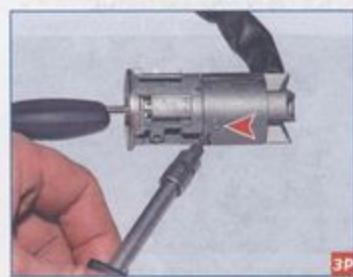
Ключом Torx T-8 отворачиваем винт...
