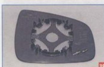
...и снимаем отражающий элемент зеркала с элементом обогрева.
