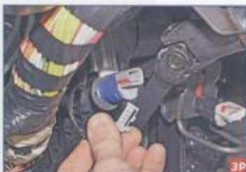
...отсоединяем колодку от разъема датчика положения педали сцепления.
