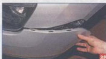
Преодолевая сопротивление фиксаторов, выводим левую боковину бампера из зацепления с пластмассовым фиксатором, закрепленным на переднем крыле.
