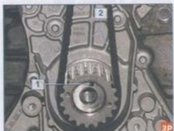
...шпоночный паз 1 на его носке должен расположиться между двумя ребрами 2 крышки блока цилиндров.
