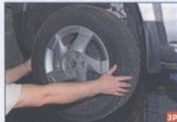
Помощник, взявшись за колесо, качает его в горизонтальной плоскости — несколько раз поочередно резко тянет заднюю часть колеса на себя, а переднюю — от себя, и наоборот. При этом...
