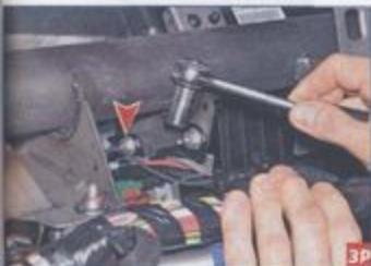
головкой «на 13» отворачиваем две
