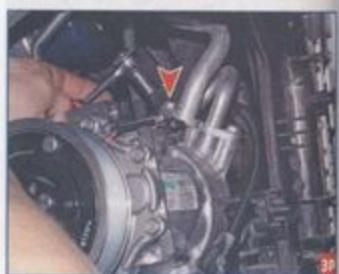
Головкой «на 10» отворачиваем болт крепления фланца трубы...
