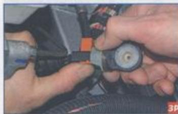
Сдвигаем зубчатый фиксатор, как показано на фото.
