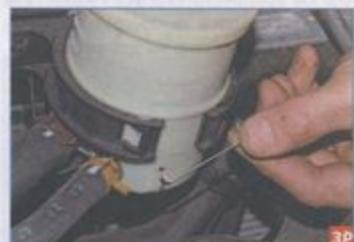
...снимаем защелку хомута крепления бачка гидроусилителя рулевого управления.
