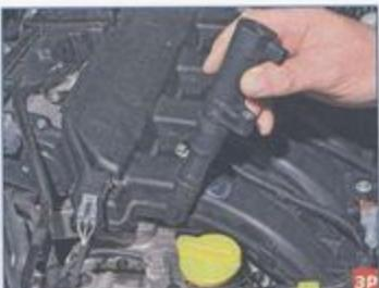
Вынимаем катушку зажигания из свечного колодца.
