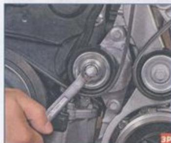
Поворачиваем кронштейн ролика по часовой стрелке, преодолевая сопротивление пружины натяжного устройства (для наглядности показано на снятом двигателе)...
