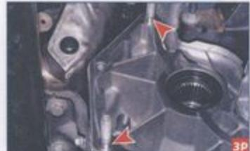
Установочные втулки картера раздаточной коробки
