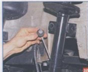
Отсоединяем стойку стабилизатора поперечной устойчивости от кронштейна амортизаторной стойки (см. «Снятие стойки стабилизатора поперечной устойчивости», с. 198).
