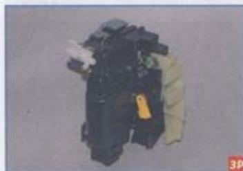
Замок передней двери с электроприводом.
