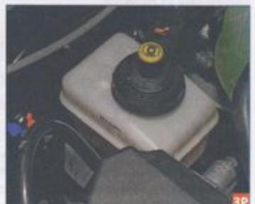
На бачке выполнены метки MIN и MAX, между которыми должен находиться уровень рабочей жидкости.
