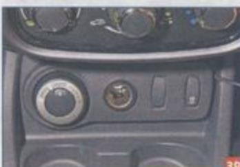
...отверткой поддеваем накладку...
