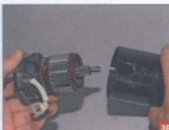
Вынимаем якорь со щеткодержателем из корпуса стартера.
