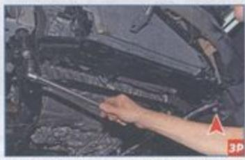
Головкой «на 18» ослабляем затяжку двух болтов переднего крепления подрамника к кузову...
