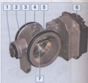
Дроссельный узел: 1 – ось дроссельной заслонки; 2 – уплотнительное кольцо патрубка соединения с ресивером; 3 – корпус; 4 – отверстие для подсоединения трубы клапана продувки адсорбера; 5 – уплотнительное кольцо патрубка соединения с корпусом воздушного фильтра; 6 – блок управления дроссельного узла; 7 – дроссельная заслонка
