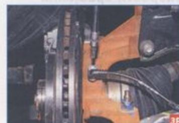
Ключом Toght T-30 отворачиваем винт крепления датчика к поворотному кулаку...
