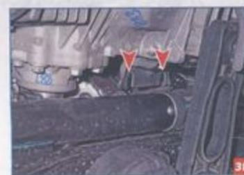
...и выводим болты из пазов кронштейна коробки передач.
