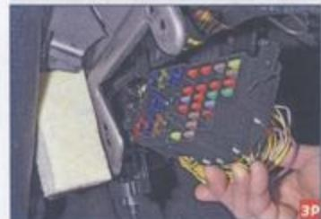
Снимаем монтажный блок предохранителей...
