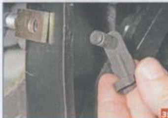
...и вынимаем палец из отверстий педали и проушины толкателя. Головкой «на 13» отворачиваем четыре гайки крепления вакуумного усилителя к щитку передка...
