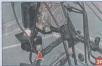
Головкой «на 13» отворачиваем два болта крепления кронштейна блока ABS к кузову...
