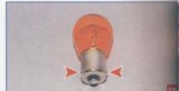
...два выступа, расположенные несимметрично относительно оси лампы, должны войти в соответствующие пазы патрона.
