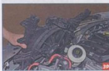
...и вынимаем вентилятор в сборе с кожухом из моторного отсека.
