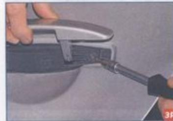
Снаружи двери ключом Torx T-20 отворачиваем винт крепления ручки.
