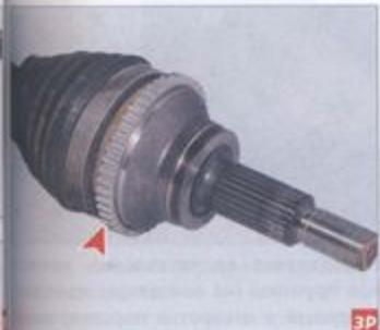
**Задающий диск датчика скорости вращения заднего колеса автомобиля 4x4 нахлопсан на корпус наружного шарнира привода колеса**
