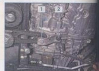
Головкой «на 21» отворачиваем 1 и ослабляем затяжку болта 2 крепления опоры и кронштейна опоры к коробке передач.
