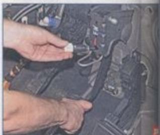
Надавив на педаль тормоза, вставляем выключатель в отверстие кронштейна педального узла, обеспечив совпадение выступов на корпусе выключателя с пазами в отверстии.
