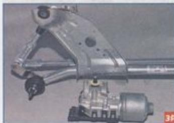
...и снимаем мотор-редуктор.
