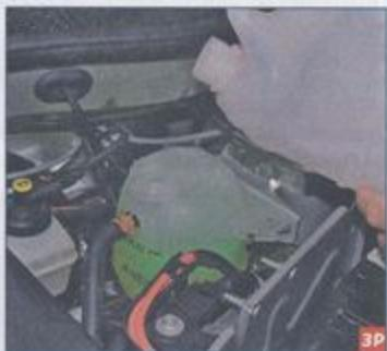
...и доливаем в бачок охлаждающую жидкость, немного не доводя уровень до метки MAXI.
