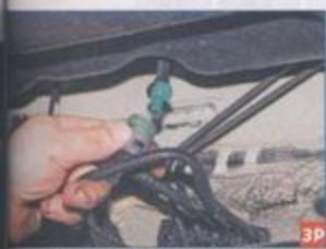
Прижав на фиксатор наконечника (серого цвета) трубы подвода топлива к фильтру, отсоединяем наконечник трубы, соединяющейся со штуцером крышки топливного модуля.
