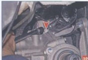
Головкой «на 13» отворачиваем нижний болт крепления стартера.
