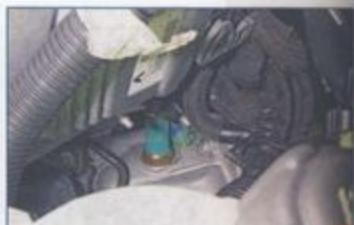
...и отсоединяем колодку от выключателя.
