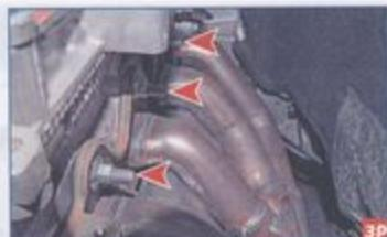
Высокой головкой «на 10» отворачиваем девять гаек крепления выпускного коллектора к головке блока цилиндров (на фото видны не все гайки).
