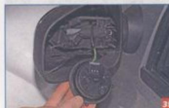
Выводим блок мотор-редукторов из корпуса зеркала.
