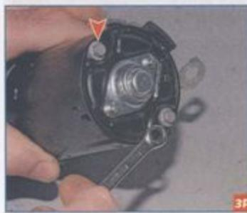
Накидным ключом «на 7» отворачиваются два стяжных болта.
