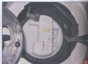
Упираясь стержнем монтажной лопатки во впадины отверстия, выполненного в панели пола кузова, наконечником лопатки толкаем против часовой стрелки прижимное кольцо за выступы. Возможно, процедуру придется повторить несколько раз, упираясь лопаткой в разные выступы по окружности кольца.
