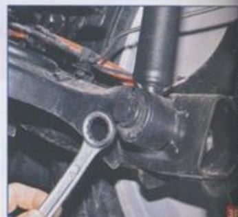
...накидным ключом или головкой «на 21» отворачиваем болт нижнего крепления амортизатора к рычагу балки...
