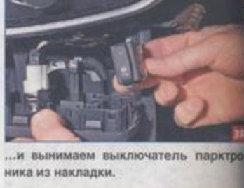
...и вынимаем выключатель парктроника из накладки.
