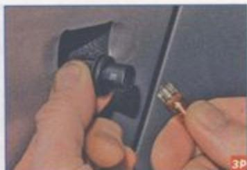
Потянув лампу, вынимаем ее из патрона...
