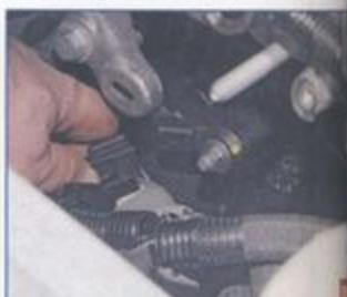
Нажав на фиксатор колодки жгута проводов системы управления двигателем, отсоединяем колодку от разъема датчика.
