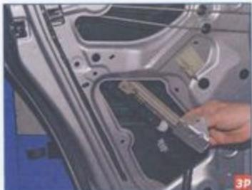
...и вынимаем направляющую стекла через технологическое отверстие во внутренней панели двери.
