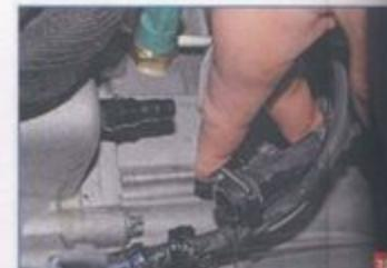
Нажав на пружинный фиксатор наконечника, снимаем наконечник трубы с переходника.
