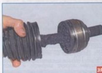
Сняв хомуты с чехла, снимаем чехол с корпуса наружного шарнира и сдвигаем чехол по валу в сторону внутреннего шарнира.
