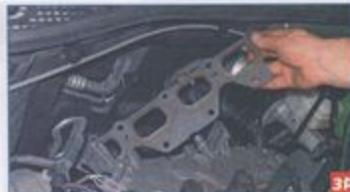
Снимаем металлическую прокладку выпускного коллектора.
