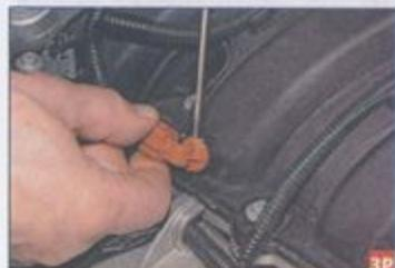
Поддеваем лезвием тонкой шлицевой отвертки фланец датчика и, преодолевая сопротивление фиксаторов датчика...
