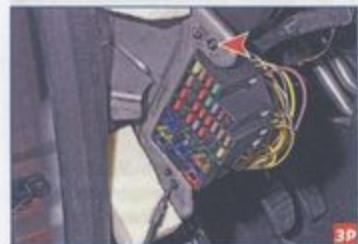
...ключом Торх Т-20 отворачиваем два самореза крепления монтажного блока.
