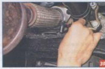
Головкой «на 10» отворачиваем два болта крепления теплозащитного экрана к подрамнику...
