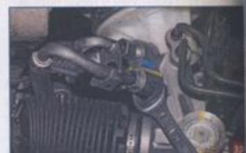
Ключом «на 17» отворачиваем штуцер трубки сливной магистрали.
