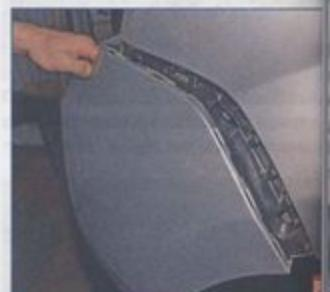
Преодолевая сопротивление фикси-ров, выводим правую боковину бам-пера из зацепления с пластмассо-вым фиксатором, закрепленным на ку-зове. Аналогичную операцию выпол-няем с левой стороны автомобиля. Аккуратно отводим задний ба-мпер от кузова...
