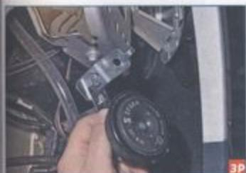
Снимаем сигнал с кронштейном.
