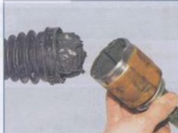
...и снимаем корпус шарнира.
