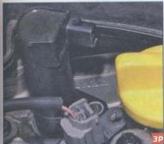
Поворачиваем клапан системы изменения фаз, освобождая фланец катушки.
