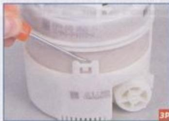
Отверткой освобождаем три фиксатора стакана...
