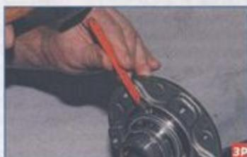
...и, нанося удары молотком по зубилу, сдвигаем внутреннее кольцо подшипника по ступице.
