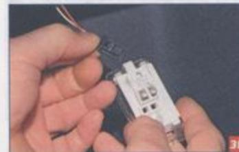
...отсоединяем колодку от разъема плафона.
