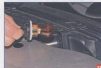
...и вынимаем патрон с лампой из корпуса блок-фары.
