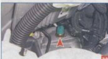
Выключатель установлен сверху на коробке передач, под площадкой аккумуляторной батареи.
