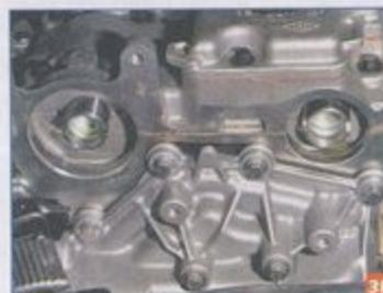
...пока пазы на торцах распределительных валов не займут горизонтальное положение (расположатся параллельно плоскости разъема крышки и головки блока цилиндров) и будут смешены вниз относительно осей распределительных валов. Для фиксации распределительных валов при замене ремня из металлической пластины толщиной 5 мм можно изготовить простейшее приспособление (см. эскиз).
