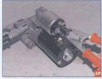
...соединяем проводами «плюсовой» вывод аккумуляторной батареи с нижним контактным болтом тягового реле,
