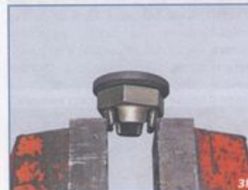
...но перед ее установкой следует обжать лепестки буртика гайки в тисках. Снимаем колесо и устанавливаем автомобиль на подставку заводского изготовления.
