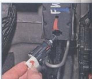
Повернув выключатель против часовой стрелки, вынимаем его из отверстия кронштейна педального узла. Перед установкой нового выключателя...
