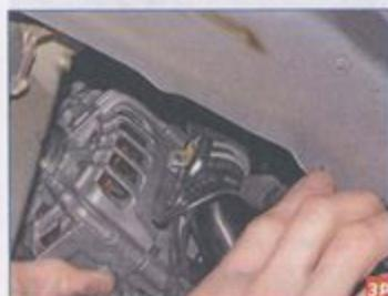
Раздвижными пассатижами сжимаем концы хомута крепления подводящего шланга радиатора и сдвигаем хомут по шлангу.
