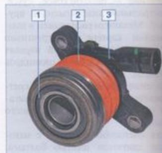
Рабочий цилиндр с подшипником выключения сцепления: 1 – подшипник выключения сцепления; 2 – защитный чехол; 3 – рабочий цилиндр
