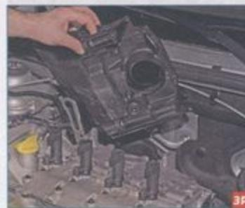
После демонтажа ресивера можно извлечь корпус воздушного фильтра из моторного отсека.
