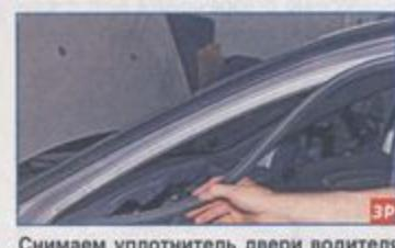
Снимаем уплотнитель двери водителя с отбортовки кузова в зоне передней стойки и панели приборов.
