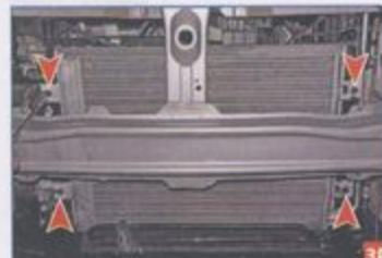
Головкой «на 8» отворачиваем четыре самореза крепления конденсатора системы кондиционирования воздуха к радиатору.
