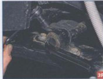
Головкой «на 13» отворачиваем два болта крепления скобы штанги стабилизатора к подрамнику.
