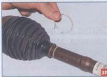
Раскрай замок хомута, снимаем хомут.
