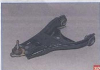
Рычаг подвески в сборе с шаровой опорой и сайлент-блоками.
