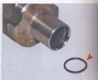
В соединении шлицевой ступицы корпуса внутреннего шарнира привода правого колеса и вала раздаточной коробки установлено резиновое уплотнительное кольцо
