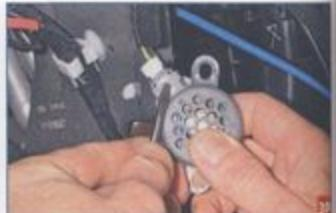
Нажав отверткой на фиксатор колодки проводов...
