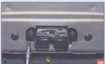
Ключом Torx T-30 отворачиваем два винта крепления замка...
