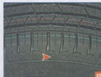
В местах нахождения индикаторов износа на боковинах шин нанесены метки в виде букв TWI.
