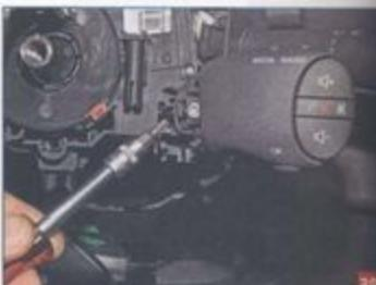
Ключом Torx T-20 отворачиваем винт крепления пульта...
