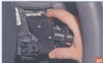
Вынимаем переключатель из соединителя.
