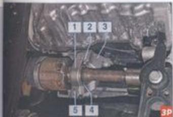
Промежуточная опора привода правого колеса: 1 – крышка опорного подшипника; 2 – ось крышки; 3 – кронштейн блока цилиндров; 4 – подшипник; 5 – болт крепления крышки
