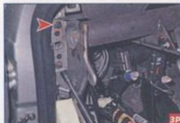
Головкой «на 13» отворачиваем два болта крепления поперечной балки с левой стороны.
