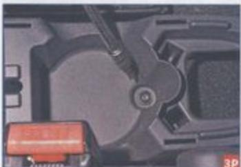
Тем же инструментом отворачиваем саморез крепления задней части облицовки туннеля пола в задней нише для стакана.
