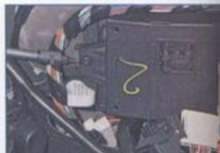
Ключом Торх Т-20 отворачиваем саморез крепления блока...
