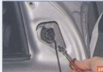
Ключом Торх Т-20 отворачиваем два самореза крепления зеркала к двери...
