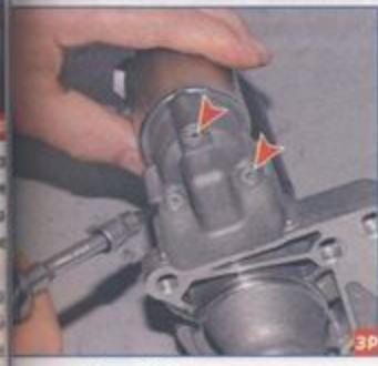
Болтом Torx T-25 отворачиваем три винта крепления тягового реле.
