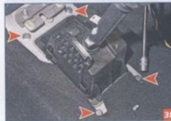
В салоне автомобиля головкой «на 10» с удлинителем отворачиваем четыре болта крепления корпуса механизма управления коробкой передач к туннелю пола.
