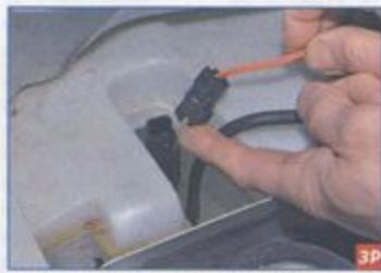
Отжав фиксатор колодки проводов, отсоединяем колодку от насоса омывателя.
