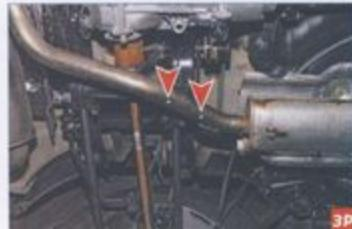
Расположение меток на трубе между дополнительным и основным глушителями на автомобиле 4x4
