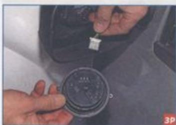
...отсоединяем колодку от разъема блока...
