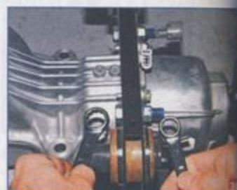
Накидным ключом «на 16» отворачиваем две гайки крепления кронштейна передних опор, удерживая болты ключом «на 18»...
