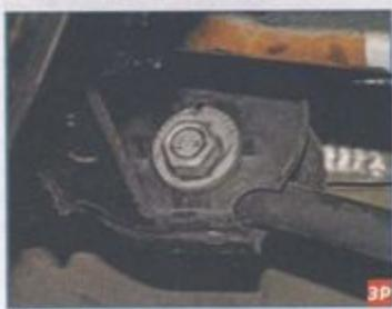
Положение головки регулировочного болта при этом можно не помечать. Устанавливаем регулируемый упор под кулак задней подвески и поджимаем кулак.
