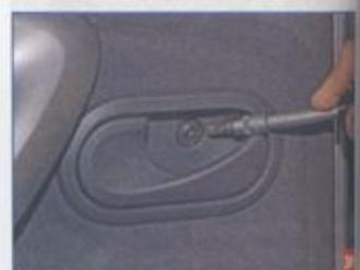
Ключом Торх Т-30 отворачиваем винты крепления внутренней ручки двери...
