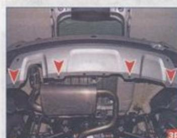
...ключом Torx T-20 отворачиваем четыре самореза нижнего крепления бампера.
