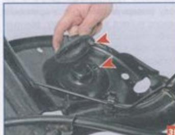
...штифт прокладки вошел в отверстие кронштейна (для наглядности показано на снятой балке).
