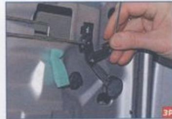
Сняв промежуточный рычаг тяги блокировки замка с оси, поворачиваем его так, чтобы тяга вышла из паза рычага...
