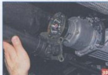
Сдвинув вал вперед, выводим центрирующий буртик фланца вилки шарнира из фланца электромагнитной муфты. Проволокой подвязываем карданный шарнир к фланцу электромагнитной муфты.
