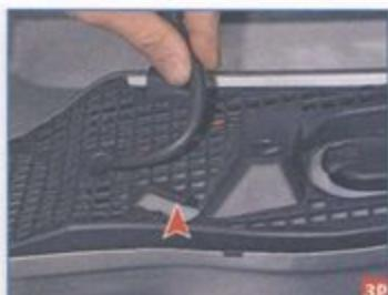
Вынимаем шланг из держателя на облицовке ветрового окна.
