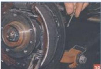
Снимаем чашку с пружиной и вынимаем опорную стойку из отверстия щита тормозного механизма.
