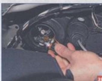
...и вынимаем лампу из корпуса блок-фары.
